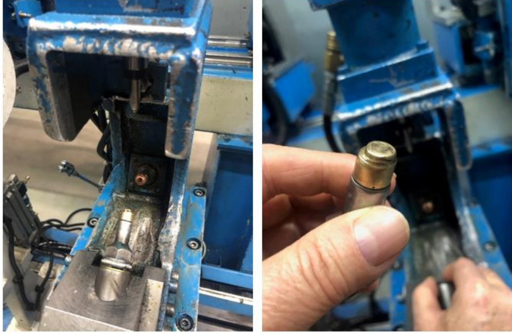
Şekil 3.27: Balans Tezgağı Pin Erime ve Oturmama Problemi.
