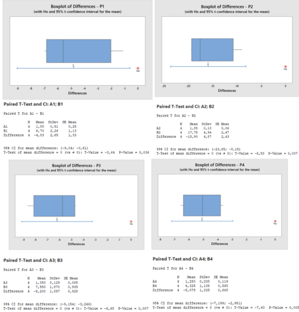
Şekil 3.26: İki Balans Tezgahı Arası T-Test Sonuçları.
