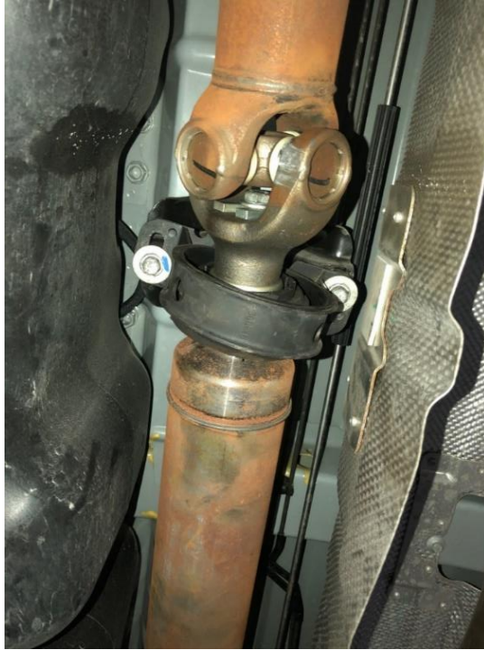
Şekil 3.14: Kardan Mili Hatalı Askı Montajı Testi.
