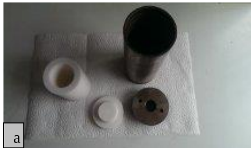
Şekil 4.1: a) Hidrotermal hücresi, b) Etöv fırın.
