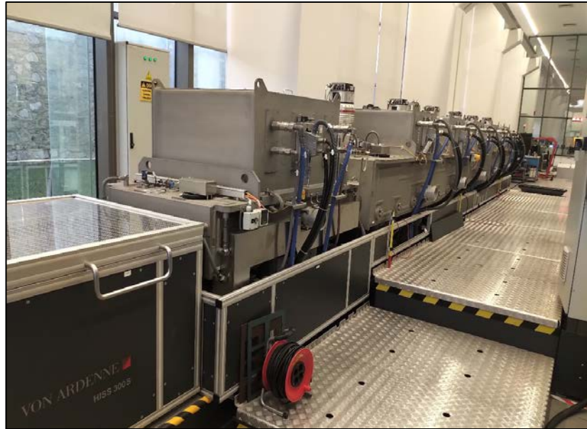
Şekil 2.1: Kaplamalı örneklerin eldesinde kullanılan Von Ardenne HISS 300 yatay kaplama cihazı.
