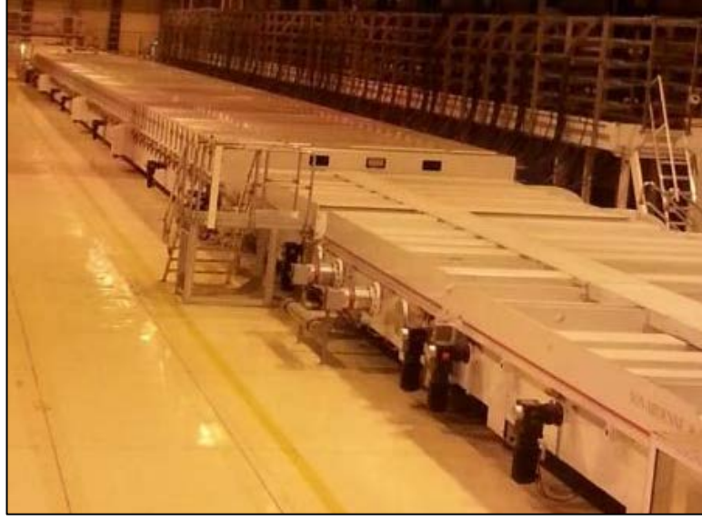
Şekil 1.4: Geniş alana sahip (3 m x 6 m) camların magnetron saçtırma metodu kullanılarak çoklu katmanlı yapıların elde edilmesinde kullanılan bir kaplama hattı.
