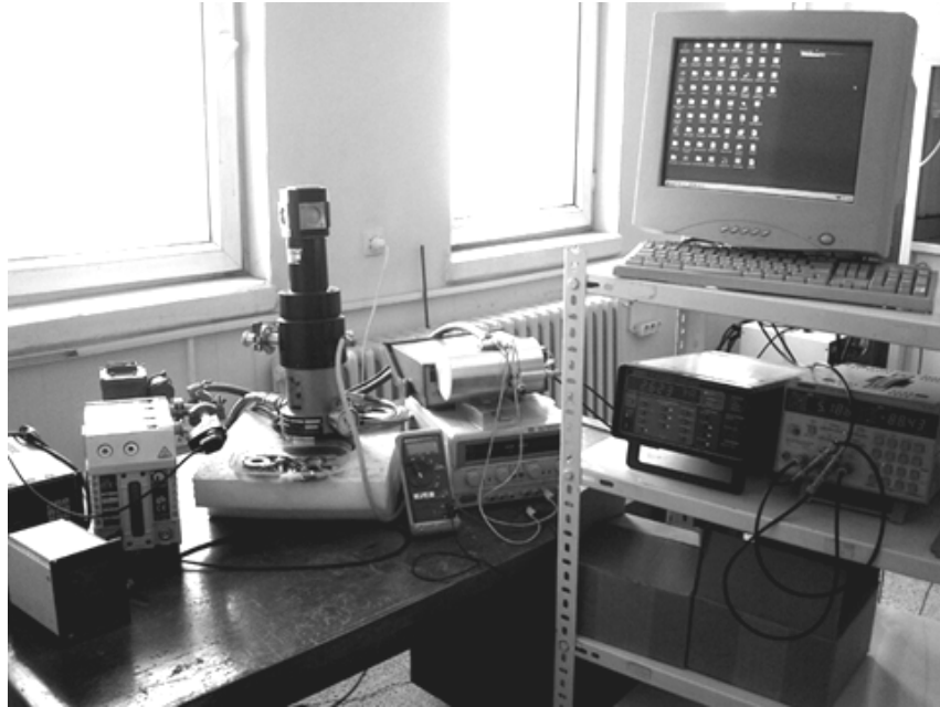
Şekil 3.2. Filmlerin a.c. ve d.c. elektriksel özelliklerinin belirlenmesinde kullanılan deneysel düzenek
