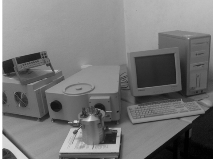
Şekil 3.3. Filmlerin dalga boyuna bağlı fotoiletkenlik özelliklerinin belirlenmesinde kullanılan deneysel düzeneği
