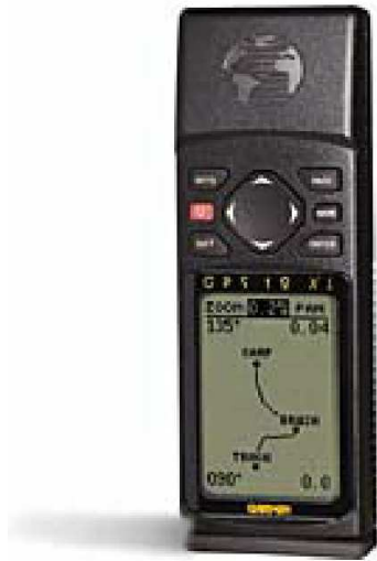
Şekil 2.9. GPS (Uydularla bağlantı kurularak bulunulan noktanın koordinatlarını ve yüksekliğini ölçmektedir.)
