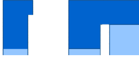
Sekil 5.23 Sapma Çikintisi Miktarına Göre Destek Yapisi İhtiyacının Belirlenmesinin Gösterimi [Materialise, 2002]
