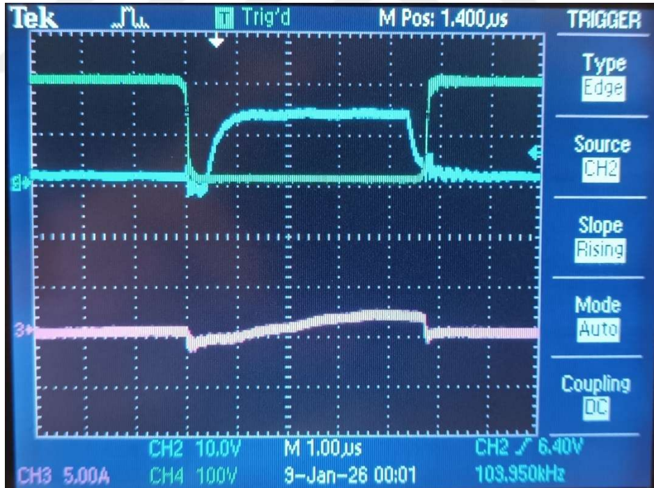
Şekil 7.16: Hafif yük Q1 MOSFET akımı (CH2: gate-source gerilimi CH4: drain-source gerilimi CH3: drain-source akımı).
