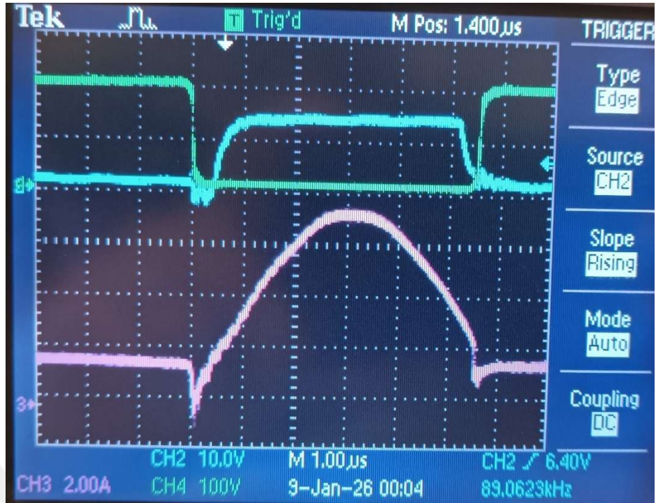
Şekil 7.15: Tam yük Q1 MOSFET akımı (CH2: gate-source gerilimi CH4: drain-source gerilimi CH3: drain-source akımı).
