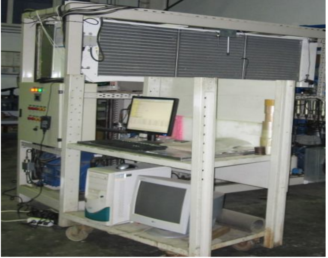
Şekil 7.6. Kaskad Sistem Deney Düzeneği Veri Alma Düzeneği Genel Görünümü
