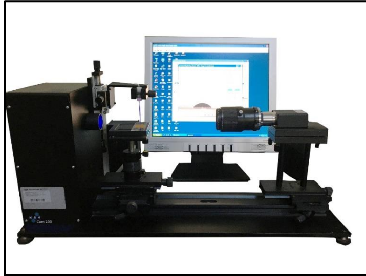
Şekil 6.9: KSV CAM 200 Contact Angle Meter cihazı ve deney düzeneği.
