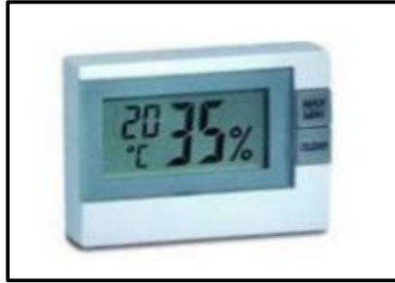
Şekil 6.6: Hücre içerisindeki bağıl nemin kontrolü için kullanılan TFA marka termo-higrometre.
