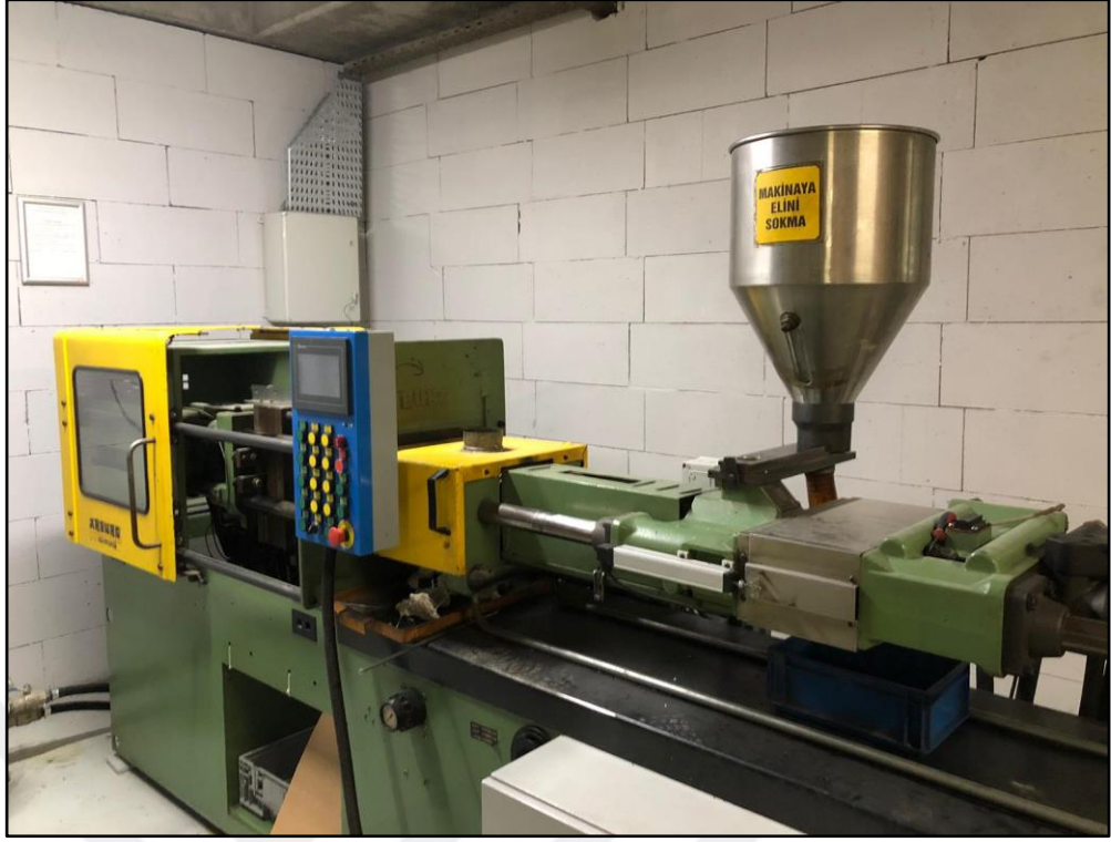
Şekil 2.7: Çalışmada kullanılan Arburg Allrounder 305 ECO marka enjeksiyon cihazı.
