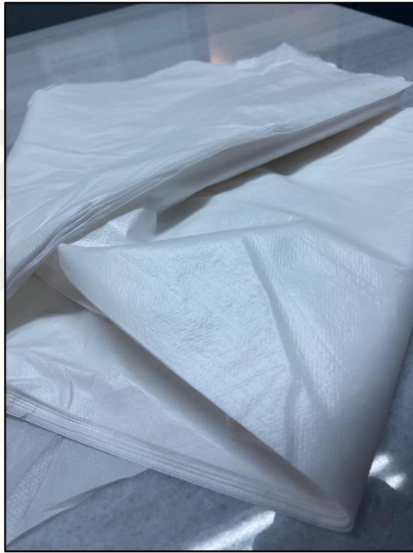
Şekil 2.1: Geri dönüşüm öncesi PP-YYPE fireleri.
