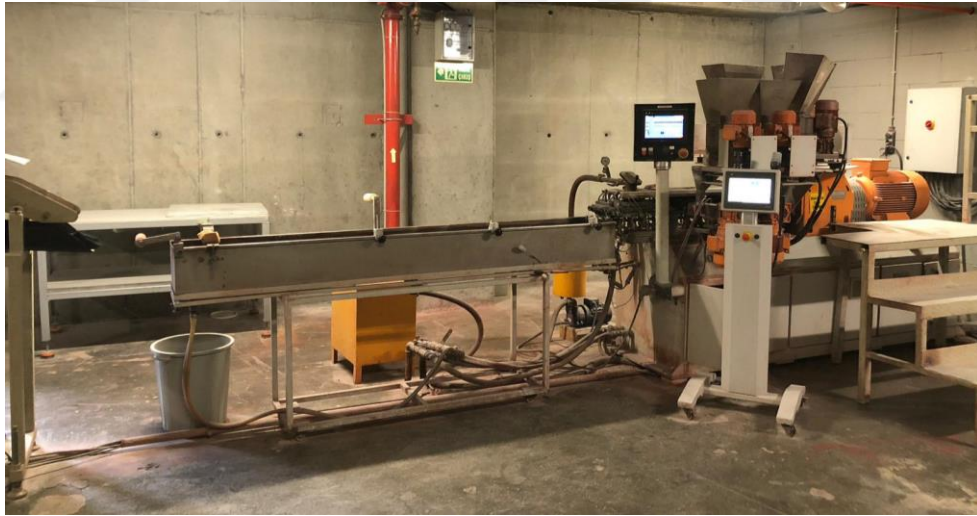
Şekil 2.5: Çalışmalarda kullanılan Poex T27 marka modelli çift vidalı ekstrüder.
