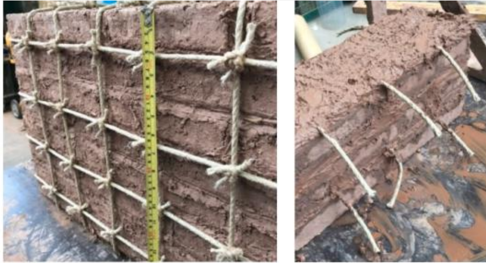
Şekil 3.8: Kenevir lifli halatlarla güçlendirilmiş bir kerpiç duvar paneli [100].
