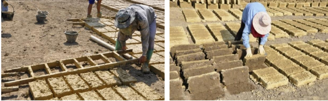
Şekil 2.30: Geleneksel yöntemle kerpiç tuğla üretimi [51].
