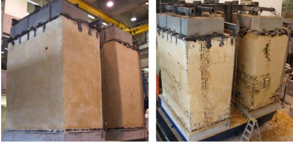
Şekil 3.11: Çelik ağ yerleştirilen numune üzerine yapılan dayanım testleri [101].
