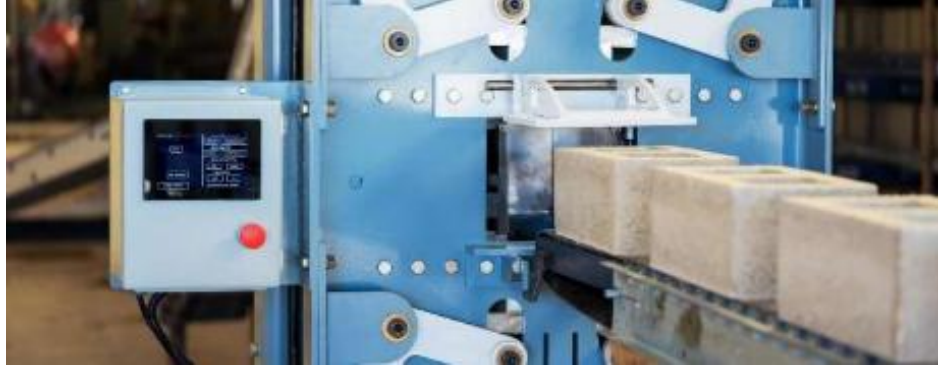
Şekil 3.19: Ekstrüder makinesi ile üretilen toprak bloklar [5].
