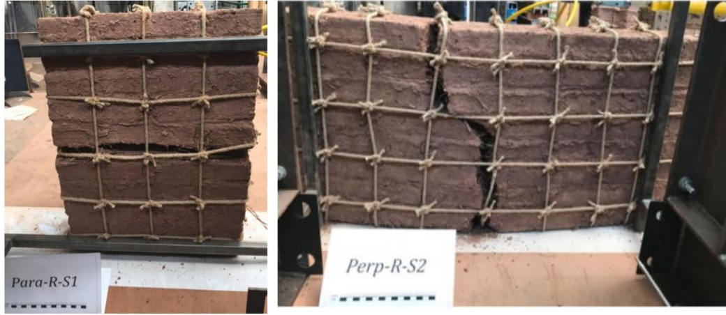
Şekil 3.9: Kenevir lifli halatlarla güçlendirilmiş kerpiç duvar paneli kuvvet testi [100].
