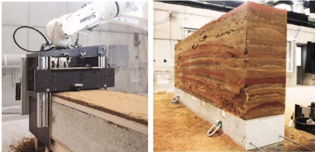
Şekil 3.28: Robotik sistem ve kayar kalıp ile sıkıştırılmış toprak üretimi [114].
