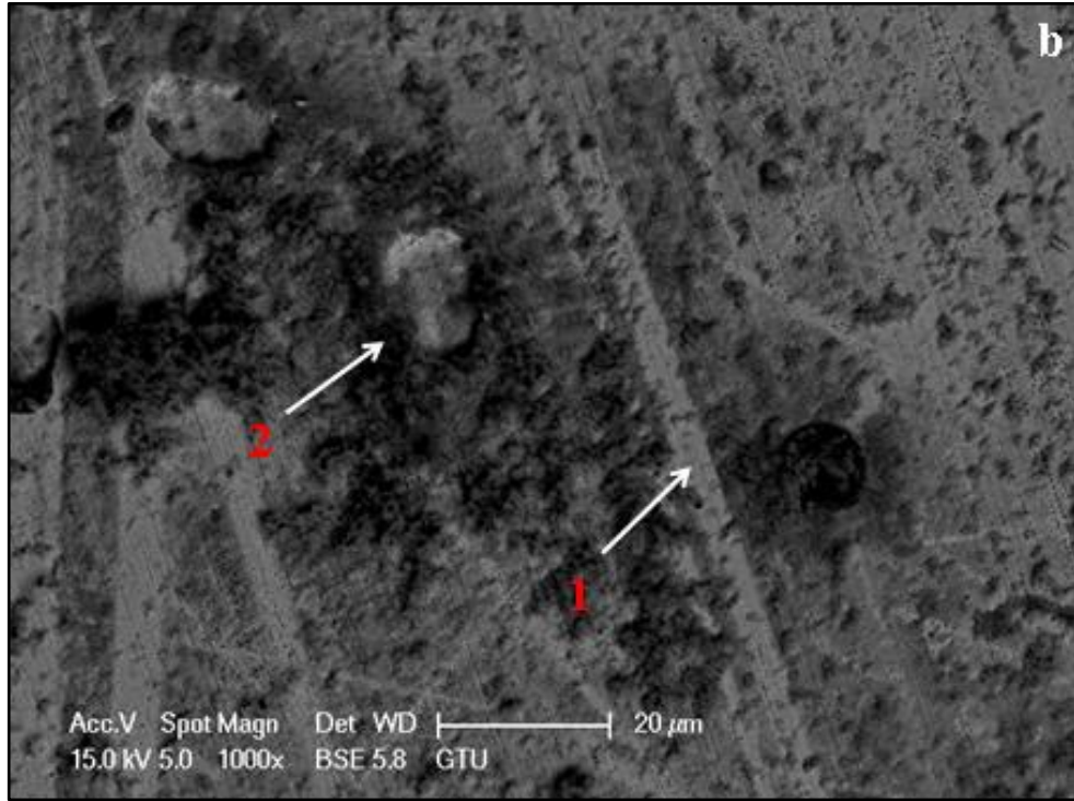
Şekil 4.46: 14 günlük YVS testi sonrası Fe 30 Mn 8 Co alaşımını yüzeyinden farklı büyütme ölçeklerinde alınan SEM görüntüleri; a)125X, b)1000X ve c)5000X.
