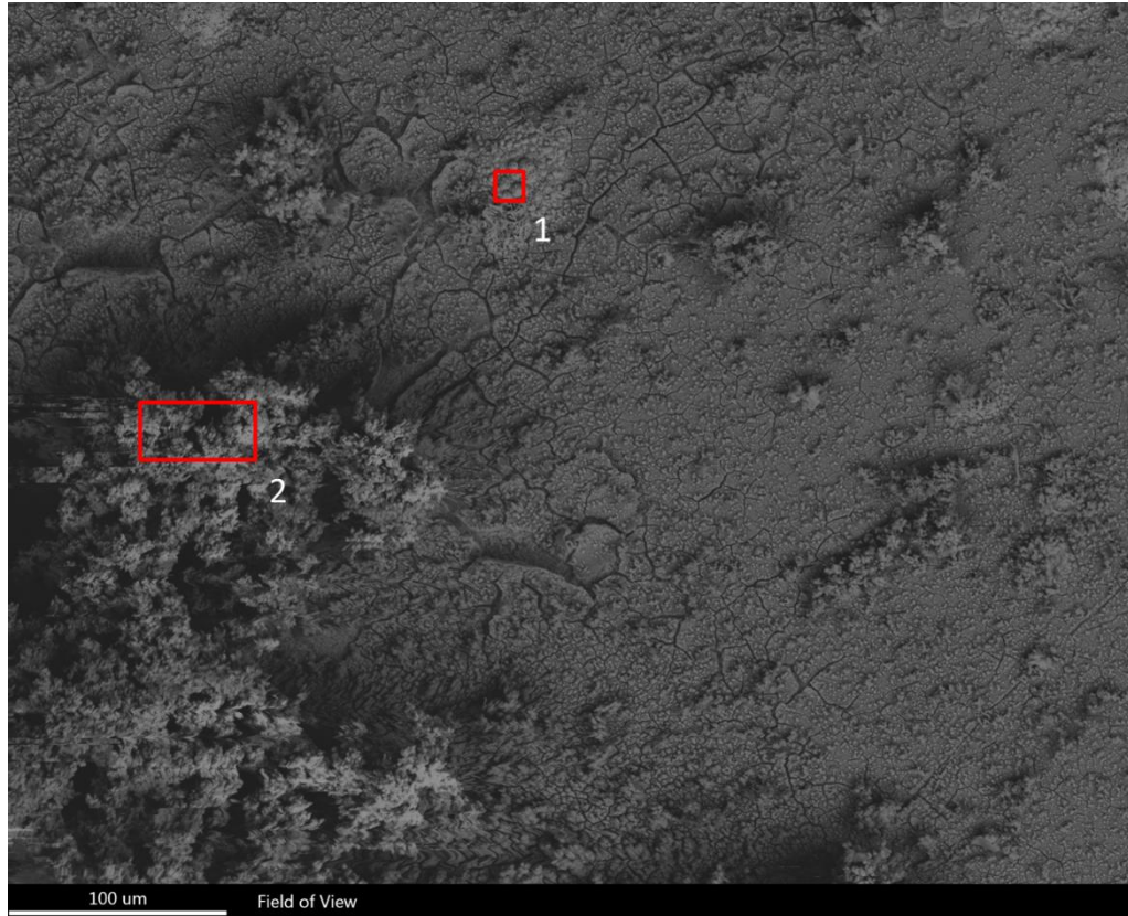
Şekil 4.13: Saf demirin 70 günlük YVS testi sonrası yüzey SEM görüntüsü ve SEM-EDS analizi yapılan bölgeler.
