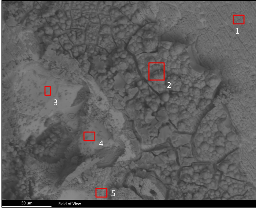
Şekil 4.12: Saf demirin 7 günlük YVS testi sonrası yüzey SEM görüntüsü ve işaretlenmiş SEM-EDS analizi yapılan bölgeler.
