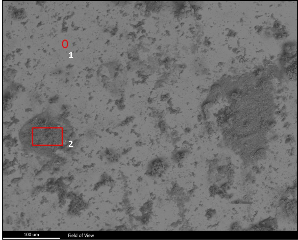
Şekil 4.30: Fe30Mn alaşımasının 7 günlük YVS testi sonrası yüzey SEM görüntüsü ve SEM-EDS analizi yapılan bölgeler.
