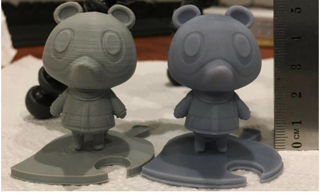
Şekil 3.21: Plastik (sol) ve reçine (sağ) baskılar [122].
