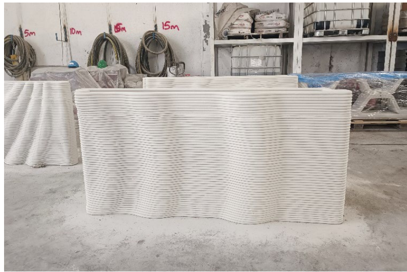
Şekil 5.9: 3D yazıcı teknolojiyle üretilen taşıyıcı olmayan duvar [246].
