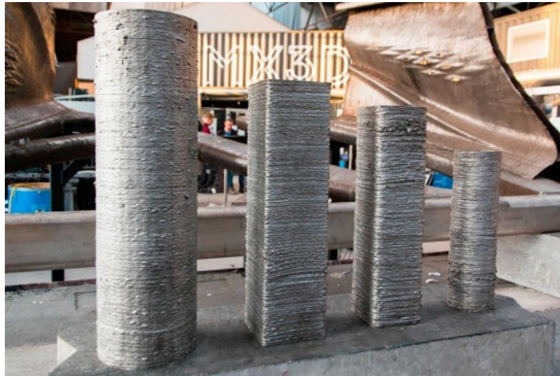
Şekil 4.5: 3D yazıcı teknolojisiyle üretilmiş metal numuneler [189].
