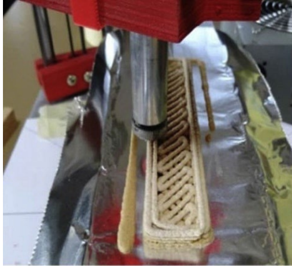
Şekil 4.3: Ahşap tozu ile 3D yazıcı teknolojisiyle üretim [16].
