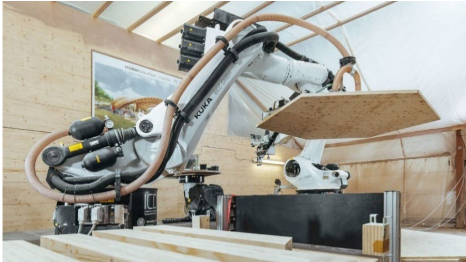
Şekil 2.12: Hafif ahşap yapı üretiminde kullanılan robot [87].
