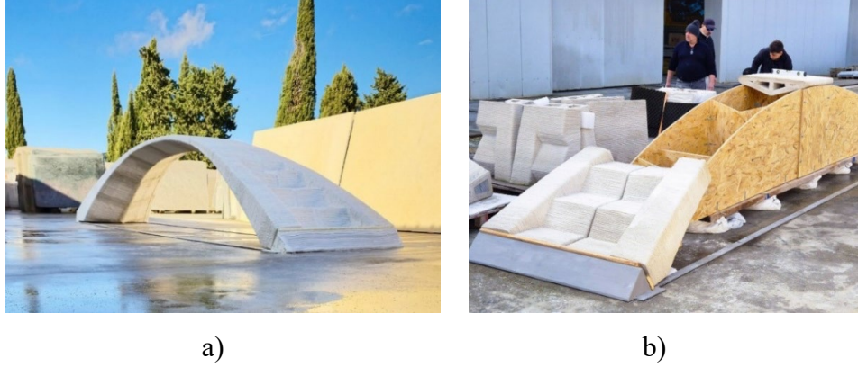
Şekil 4.56: Da Vinci's Bridge: a) köprü yapısı, b) inşası [244].
