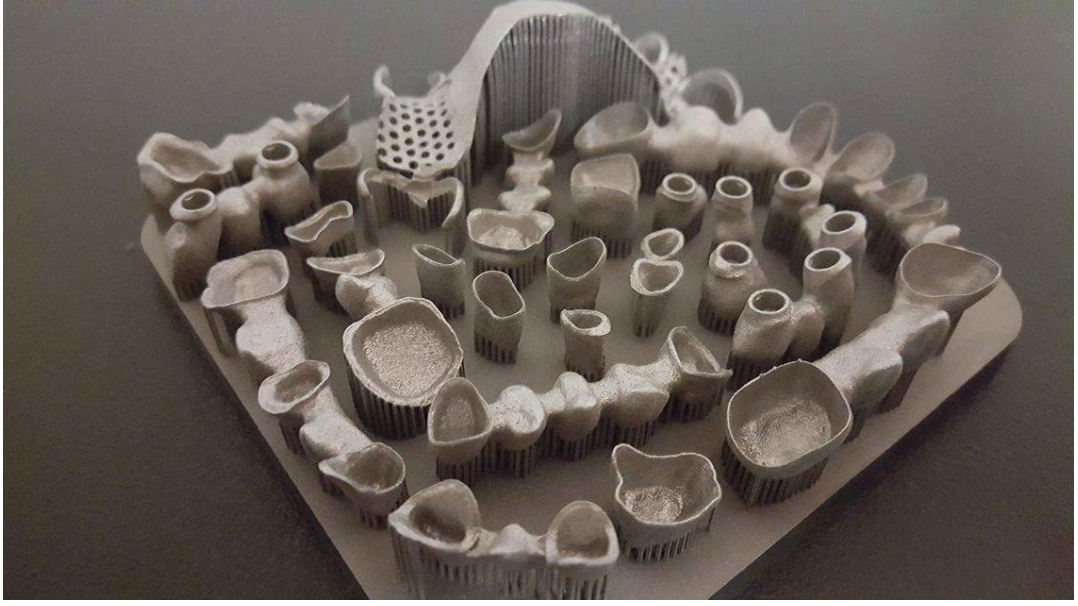
Şekil 3.22: 3D yazıcı teknolojisiyle üretilmiş metal baskı [123].
