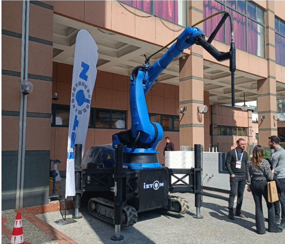
Şekil 5.3: İSTON tarafından geliştirilen 3D mobil yazıcı [246].
