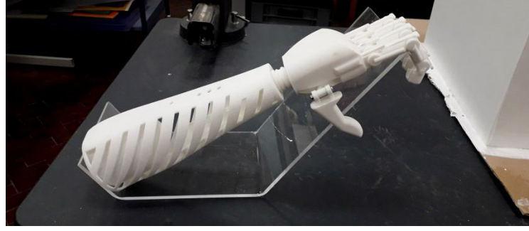
Şekil 3.29: 3D yazıcı teknolojisiyle üretilmiş protez kolu [154].
