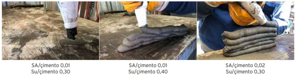
Şekil 4.7: SA/çimento ve su/çimento oranlarının işlenebilirliğe ve taşınabilirliğe etkisi [197].
