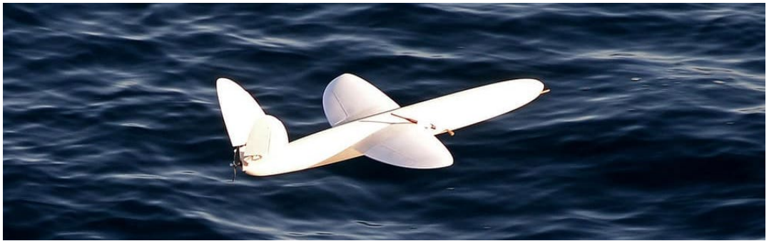
Şekil 3.37: 3D yazıcı teknolojisi üretilmiş ilk insansız hava aracı [167] .
