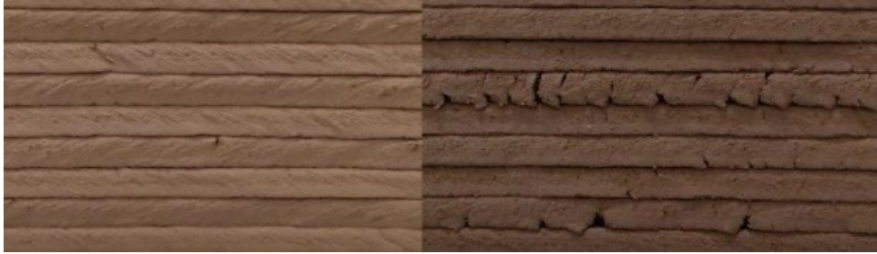
Şekil 4.8: Yapısal atıklarla oluşturulan geopolimer harçların üretimi [20].
