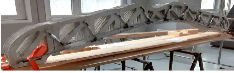
Şekil 4.30: 3D yazıcı teknolojiyle üretilmiş prekast kiriş [223].
