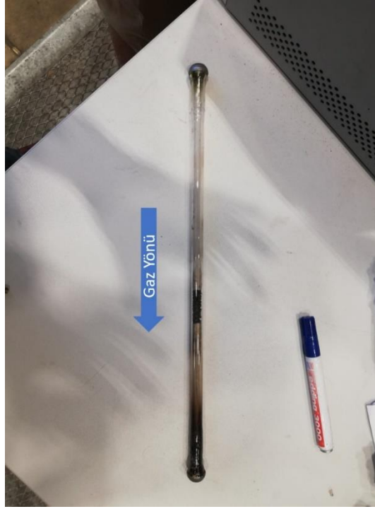
Şekil C1.9: Buhar üflemeli gazlaştırıcıda yapılan deney bitiminde kolunun fotoğrafı.
