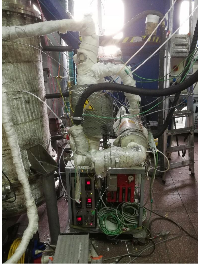
Şekil C1.3: Metal filtre ve pilot ölçekli adsorpsiyon kolonunun yandan görünüşü.
