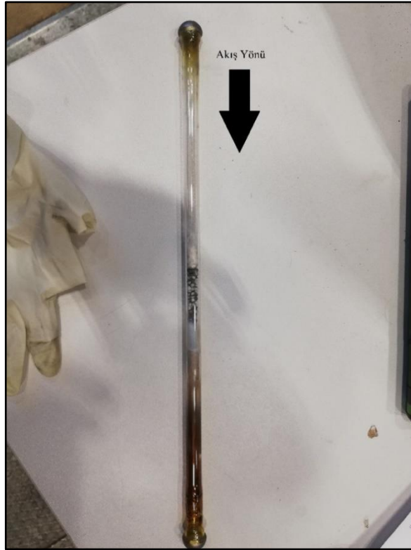
Şekil C1.18: Buhar üflemleri gazlaştırıcıda “kuru” sentez gazı ile gerçekleştirilen adsorpsiyon deneyinin sonunda kolonun son halinin fotoğrafı.
