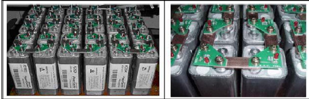
Şekil 3. 3. Süperkapasitör modülü ve süperkapasitörlerin bağlantıları
