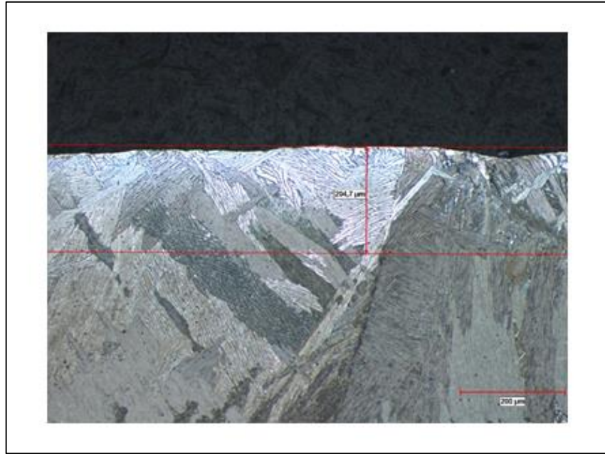
Şekil 4.4: D4 numunesinde alfa katmanı kalınlığı.
