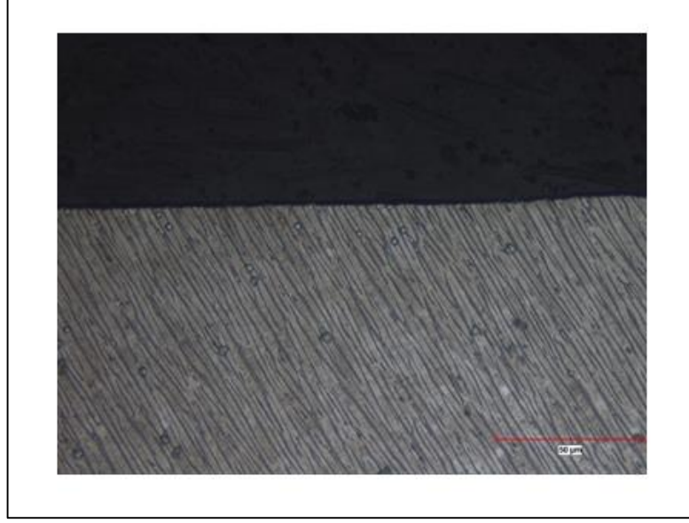
Şekil 4.5: D4 numunesinde aşındırılmış yüzey.
