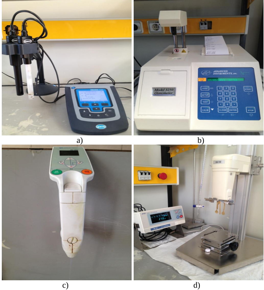
Şekil 4.2: Analizlerde kullanılan masaüstü cihazların fotoğrafları a) Multiparametre ölçer b) Osmometre c) Yoğunlukölçer d) Viskozitemetre.
