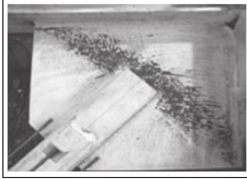
Şekil 4.4: Guse plakasında çapraz burkulması ile sağlanan uyumdan kaynaklı akma çizgisi.
