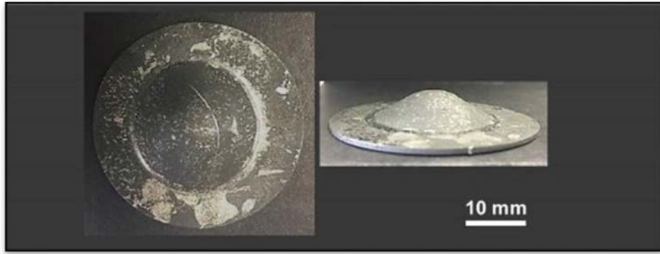
Şekil 7.75: 1 mm kalınlığında 45 mm çapında altlık kullanılarak yapılan oda sıcaklığındaki şekillendirme testi sonrası ZEK100 500C 30 dk kodlu levhanın üstten ve yandan açılı fotoğrafları.
