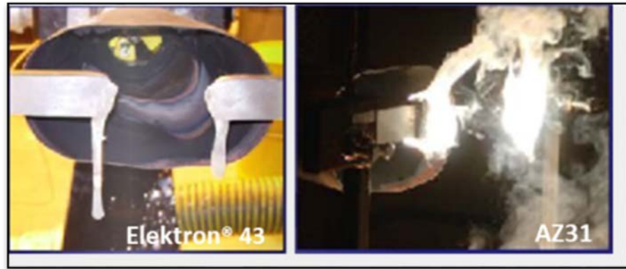
Şekil 1.13: Elektron 43 alaşımının magnezyum AZ31 alaşımına göre yanma testi karşılaştırması.
