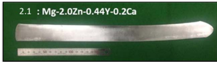
Şekil 7.42: 2.1 (Mg-2Zn-0.44Y-0.2Ca) numunesinin başarılı ılık hadde sonrası fotoğrafı.
