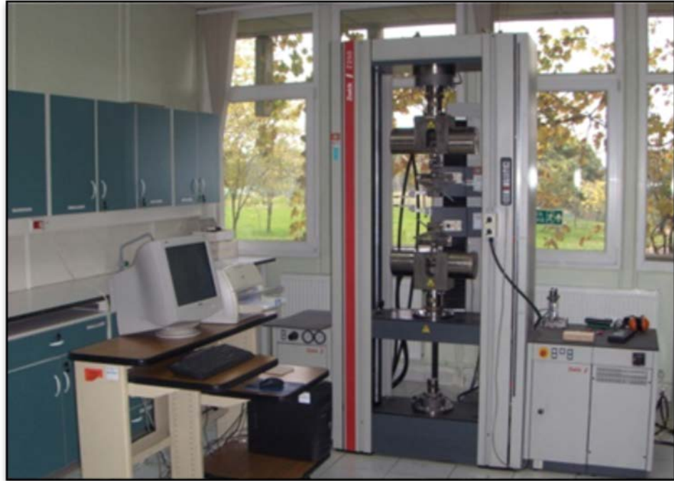
Şekil 6.9: Zwick 250 kN Üniversal Mekanik Test Cihazı.
