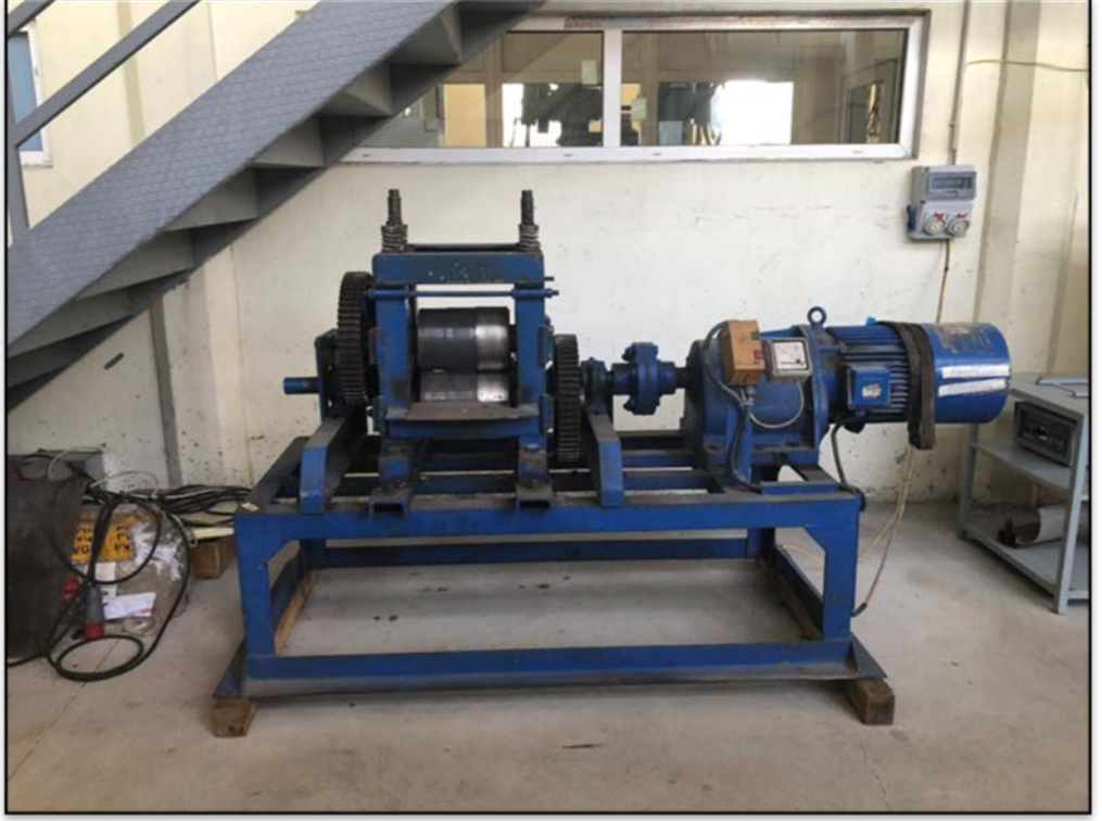
Şekil 6.5: TÜBİTAK MAM' da kullanılan hadde cihazı.
