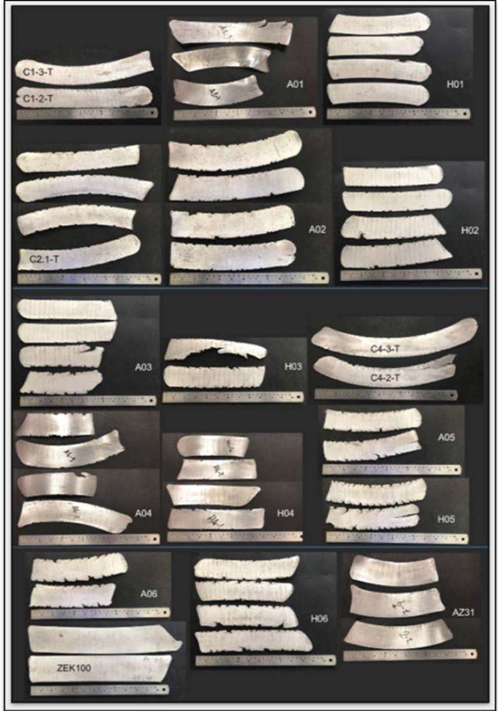
Şekil 7.45: TÜBİTAK MAM’ da yapılan ılık hadde sonrası 1 mm kalınlığındaki levhaların fotoğrafları.
