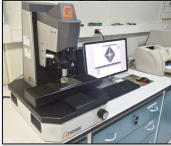
Şekil 6.10: Qness Q10 A+ Vickers mikrosertlik cihazı.
