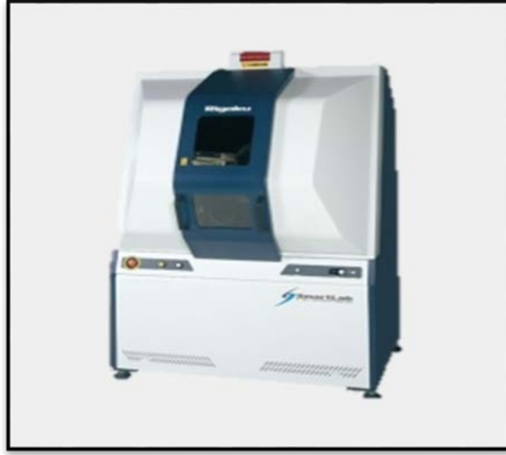
Şekil 6.3: Rigaku SmartLab x-ışını difraktometre cihazı.
