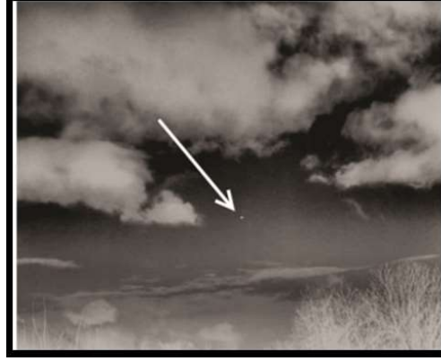
Şekil 2.2: Açık gökyüzünde, 200 m mesafedeki İHA'nın kamera ile tespiti (LWIR uzun dalga kızılötesi, 20 mm odak mesafesi).
