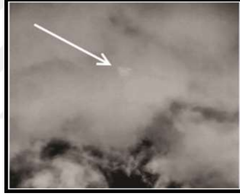
Şekil 2.3: Bulutlu bir havada, 50 m mesafedeki İHA'nın kamera ile tespiti (LWIR uzun dalga kızılötesi, 20 mm odak mesafesi).
