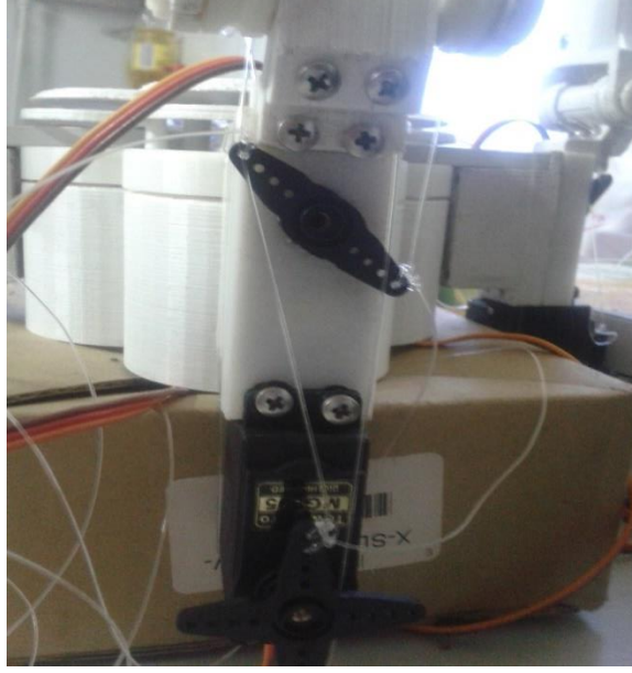
Şekil 3.1: Burkulma hareketi için eklenen servo motorlar.
