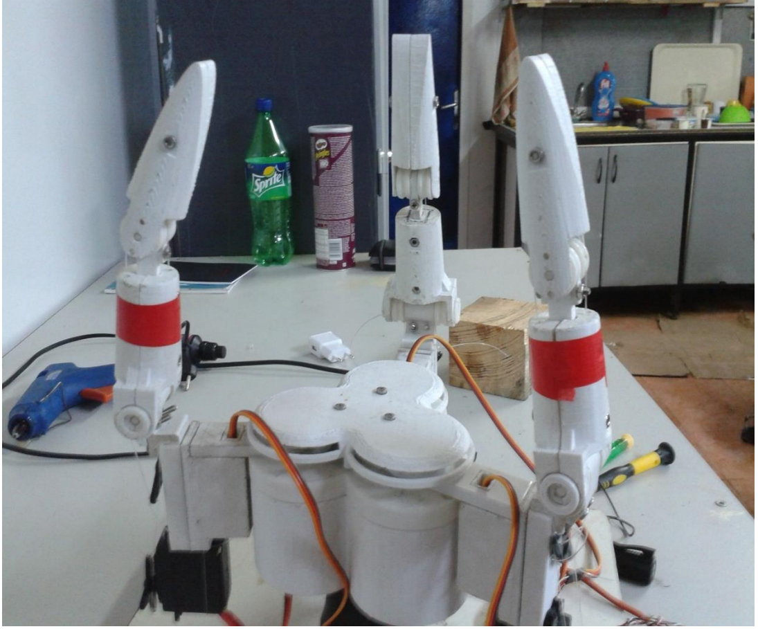
Şekil 3.2: 3 Parmaklı Kavrayıcı Robot El Son Tasarımı.
