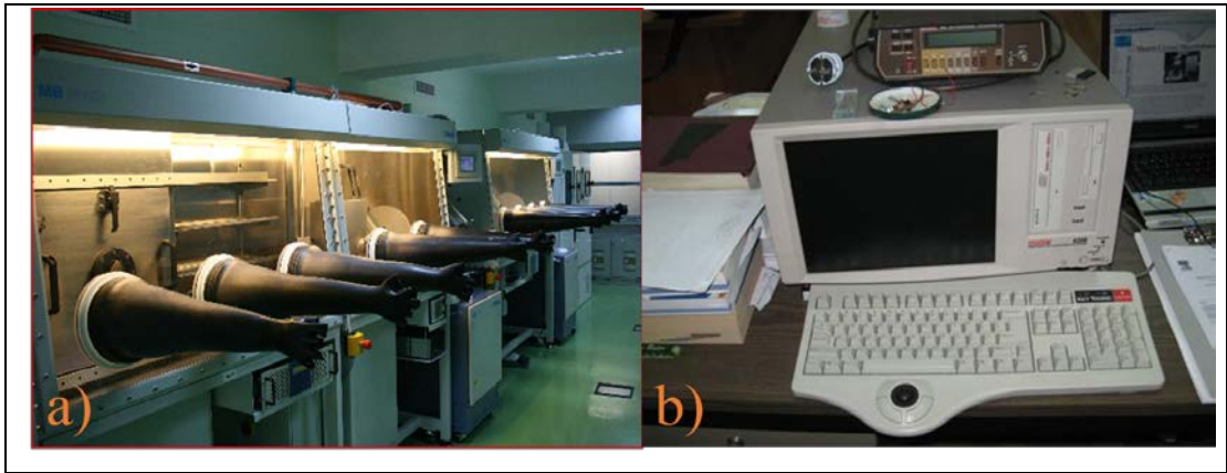
Şekil 4.7: İnce film transistör üretimi ve karakterizasyonunda kullanılan, a) Mbraun eldivenli kutu sistemi ve, b) Keithley 4200-SCS yarıiletken karakterizasyon sistemi.
