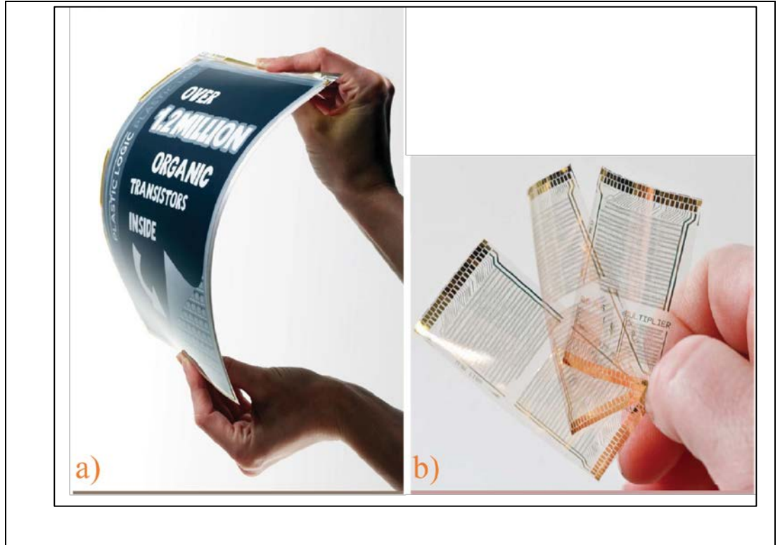
Şekil 2.1: a) 1.2 milyon OFET ile sürülen elektroforetik mürekkep tabanlı esnek ekran, b) 3381 OFET'ten oluşan 8-bitlik esnek mikro kontrolcü entegre.
