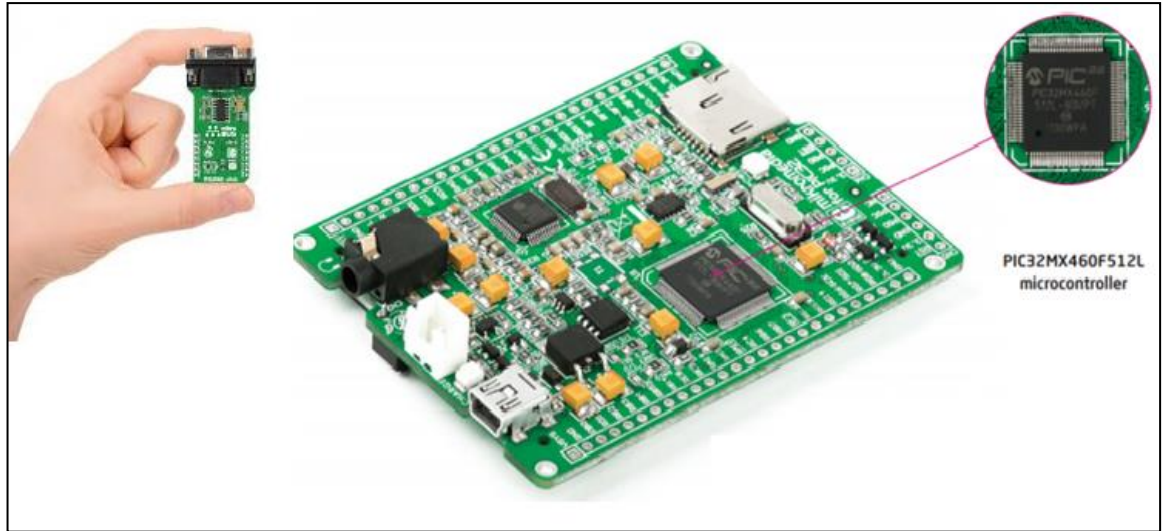
Şekil 5.28: PIC32MX460F512L geliştirme kartı.
