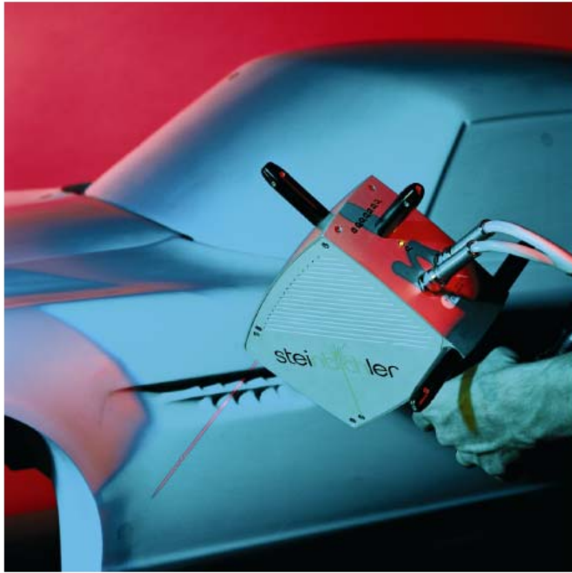
Şekil 3.2; Steinbichler T-SCAN lazer kesitli tarama sistemi
