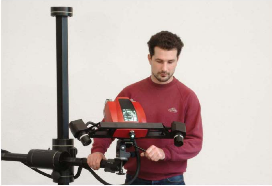
Şekil 3.40; ATOS tarayıcının kullanımı
