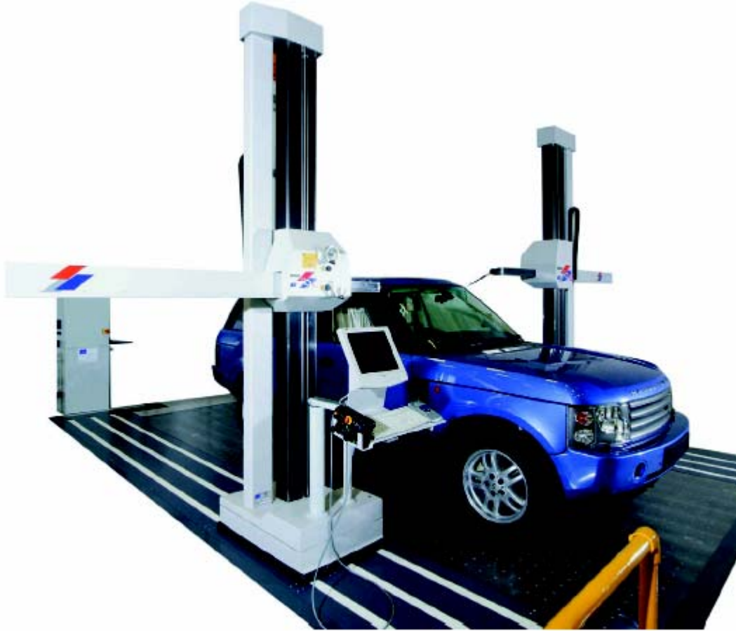
Şekil 2.16; Otomotiv sektöründe kullanılan, LK Ltd. marka koordinat ölçme tezgahı
