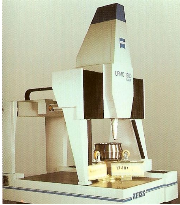
Şekil 2.15; Ultra ölçüm hassasiyetine sahip koordinat ölçme tezgahı
