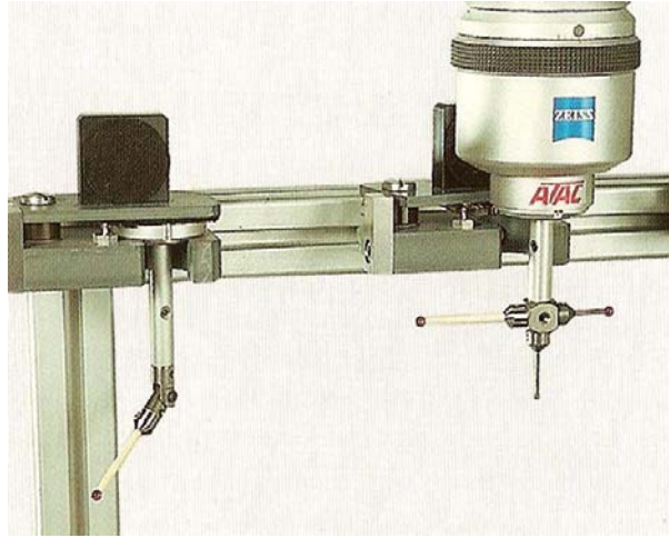
Şekil 2.7; Otomatik prop değişirme magazini
