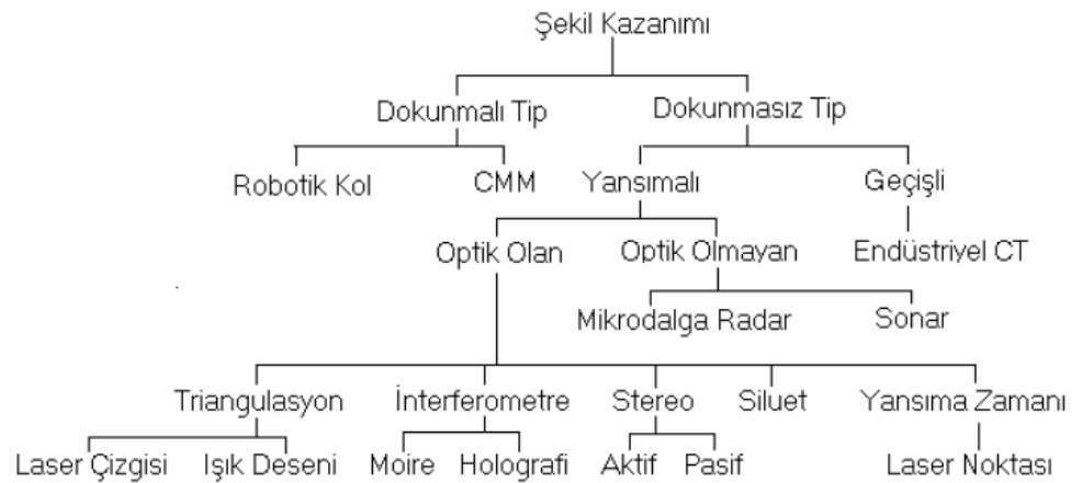
Şekil 1.5; Sayısallaştırma yöntemlerinin sınıflandırılması
