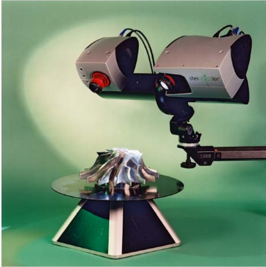
Şekil 3.3; Steinbichler COMET IV tek kameralı optik tarama sistemi
