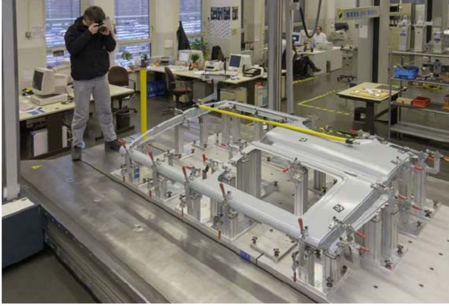
Şekil 3.42; TRITOP ile yan panel için bir referans veri setinin oluşturulması
