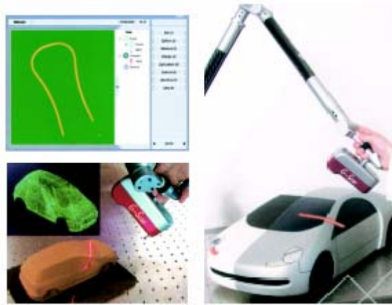
Şekil 2.17; Tasarım ve prototip alanında da sıklıkla kullanılan Fransız Romer firmasının ürettiği, lazer ölçüm ucu kullanan portatif koordinat ölçme tezgahı
