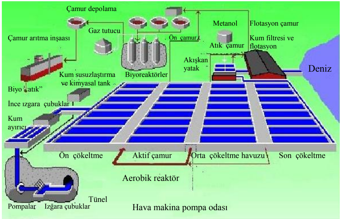
Şekil 2.1. Atıksu arıtma tesisi şematik gösterimi [Mundt, 2006]
