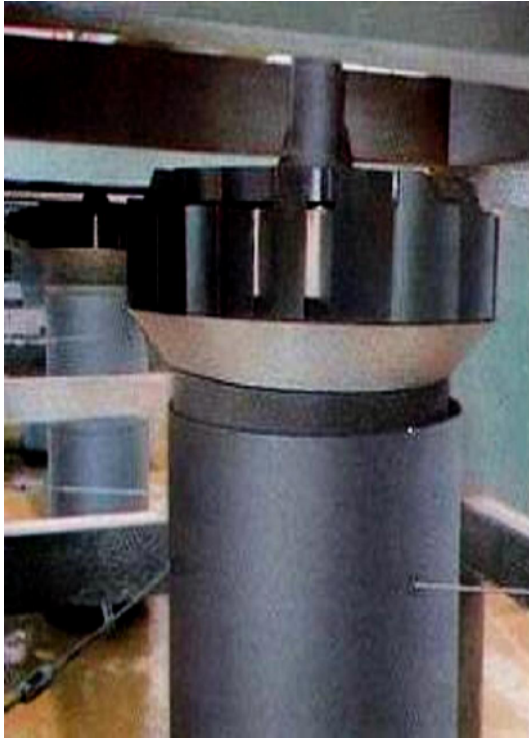
Şekil 2.24. (a) Akış borulu düşük hızlı düşey milli mekanik yüzey havalandırıcı [Biwater Treatment Limited, Brochure].
