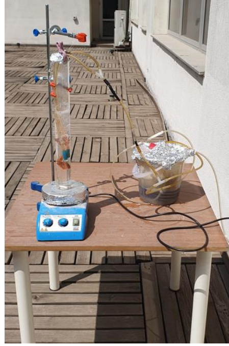
Şekil 6.35: a)Fe/HNT b)Fe/HNT-Al 2 O 3 katalizörünün kullanıldığı Güneş ışığı-PcO sistemi.
