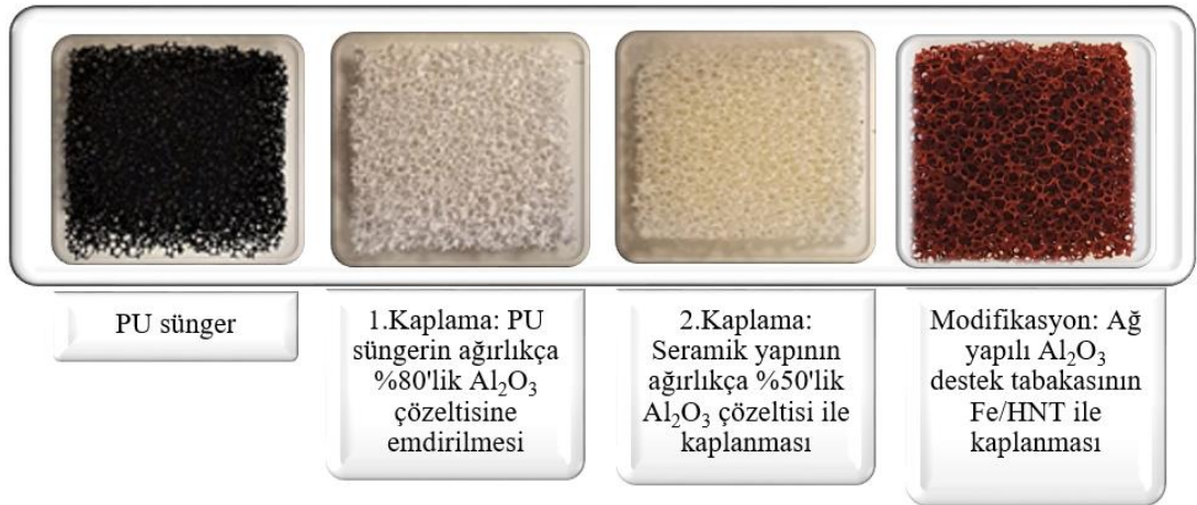
Şekil 5.8: Ağ yapılı Al 2 O 3 seramik destek yapısı ve Fe/HNT-Al 2 O 3 kompozit yarıiletken katalizörünün görüntüleri.
