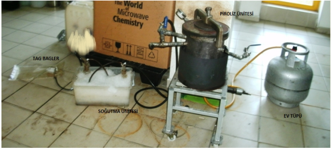
Şekil 6.2 Bitümlü şist pirolizi amacıyla kullanılan ünite
