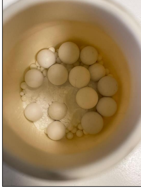
Şekil 5.10: Cam Kompozisyonu ve halloysitin karıştırılmasından sonra tozun alümina ve zirkon toprakları arasında değirmene koyulduğu hali.
