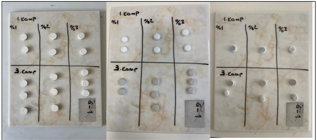
Şekil 5.11: Değirmenden alınan tozların pelletlenme sonrası, sinterleme sonrası ve zımpara sonraki görselleri.
