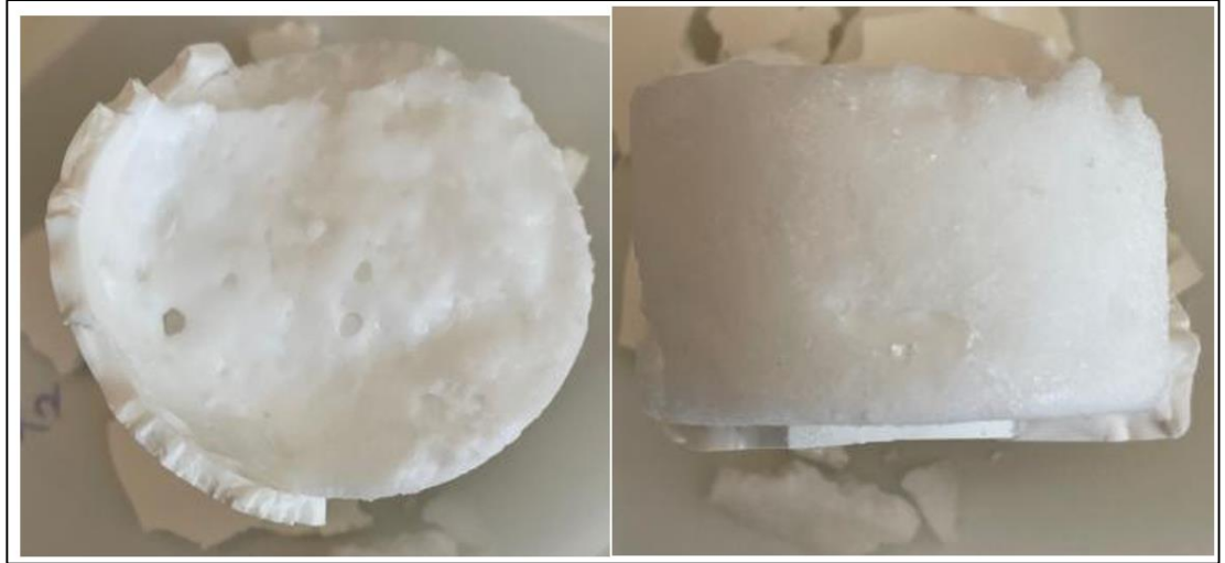
Şekil 5.4: \text{SiO}_2\text{-CaO-P}_2\text{O}_5\text{-Na}_2\text{O} Kompozisyonundan oluşan biyocam-seramik sistemi için 3. döküm sonrası elde edilen devitrifikasyona uğramış cam.
