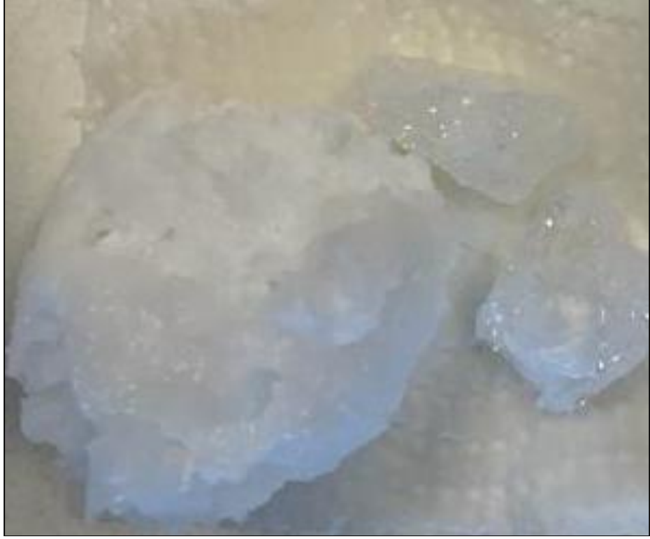
Şekil 5.2: \text{SiO}_2\text{-CaO-P}_2\text{O}_5\text{-Na}_2\text{O} Kompozisyonundan oluşan biyocam-seramik sistemi için ilk döküm sonrası elde edilen devitrifikasyona uğramış cam.
