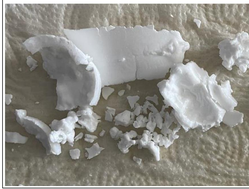
Şekil 5.5: \text{SiO}_2\text{-CaO-P}_2\text{O}_5\text{-Na}_2\text{O} Kompozisyonundan oluşan biyocam-seramik sistemi için 4. döküm sonrası elde edilen devitrifikasyona uğramış cam.
