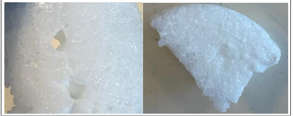
Şekil 5.3: \text{SiO}_2\text{-CaO-P}_2\text{O}_5\text{-Na}_2\text{O} Kompozisyonundan oluşan biyocam-seramik sistemi için 2. döküm sonrası elde edilen devitrifikasyona uğramış cam.
