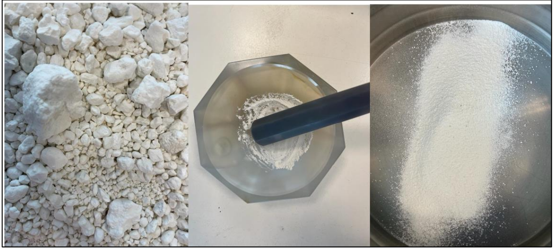
Şekil 5.1: Halloysitin kuvars havanda öğütülmeden önceki, öğütülme sırasındaki ve öğütüldükten sonraki hali.
