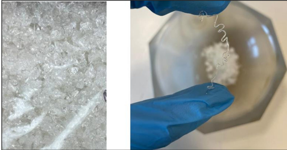
Şekil 5.9: \text{CaO-MgO-SiO}_2\text{-P}_2\text{O}_5\text{-Na}_2\text{O} Kompozisyonundan oluşan biyocam-seramik sistemi için elde edilen camın en son hali.
