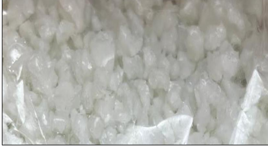
Şekil 5.8: \text{SiO}_2\text{-Al}_2\text{O}_3\text{-MgO-CaO-CaF}_2\text{-P}_2\text{O}_5\text{-Na}_2\text{O-B}_2\text{O}_3 Kompozisyonundan oluşan biyocam-seramik sistemi için elde edilemeyen devitrifikasyona uğramış camın en son hali.
