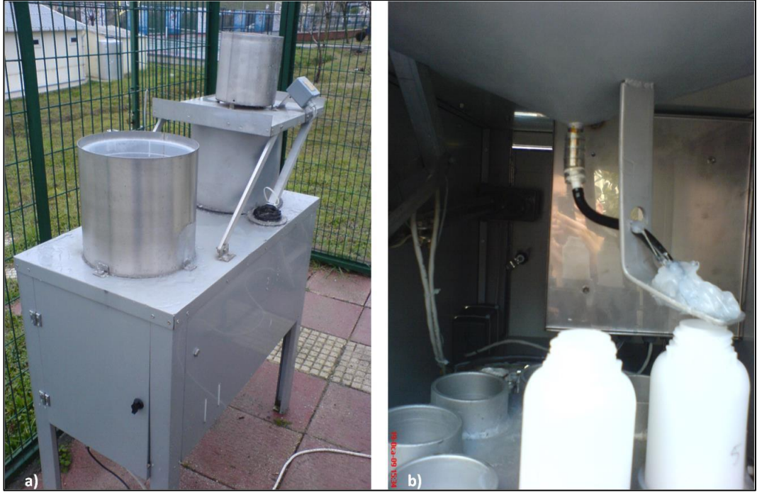
Şekil 3.10: a) Örnekleyicinin genel görünümü, b) ardışık örnekleme şişeleri ve haznesi.
