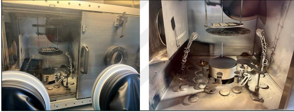
Şekil 5.8: Eldivenli kutu içerisindeki metal buharlaştırma sistemi a) Dış kabin b) İç kabin
