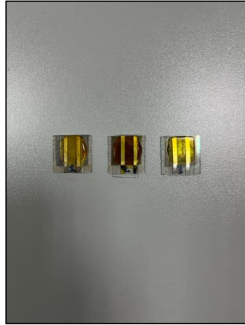
Şekil 5.10: Enkapsüle edilmiş perovskit güneş hücreleri
