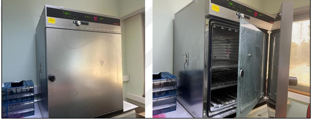
Şekil 3.26: İklimlendirme Kabini a) Dış kabin b) İç kabin
