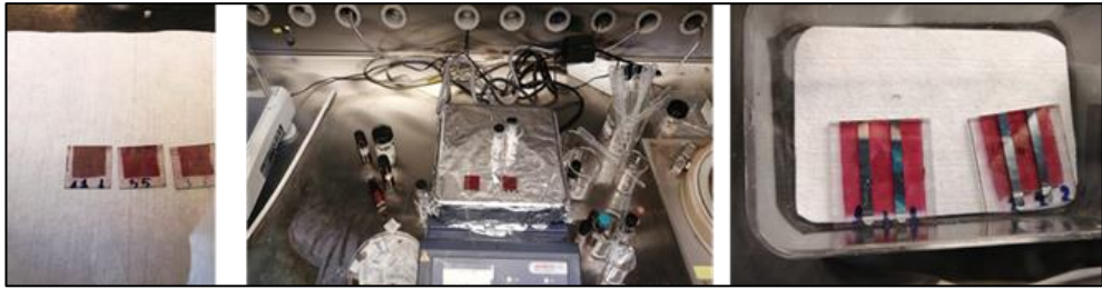
Şekil 5.44: p-i-n yapıda üretilmiş DMACsSn 2 Br 6 perovskit güneş hücresinin üretim aşamaları a) Perovskit kaplama b) Tavlama c) Metal kaplama
