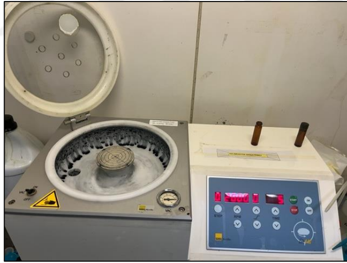
Şekil 5.4 : PEDOT:PSS kaplanırken kullanılan dönel kaplama cihazı
