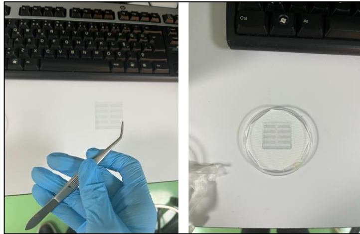
Şekil 5.2: a) ITO kaplı cam b) İletken yüzeyi belirlenmiş ITO kaplı cam
