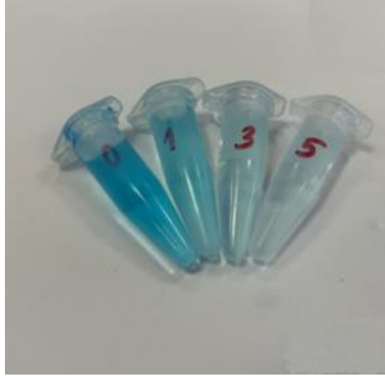
Şekil 5.32: 5 ppm metilen mavisi içeren çözeltinin FTO-ERGO/TiO 2 /Al(60) fotoelektrodu ile gerçekleştirilen giderimi sonucu gözlemlenen renk değişimi.
