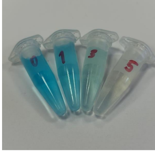
Şekil 5.34: 2 ppm metilen mavisi içeren çözeltinin FTO-ERGO/TiO 2 /Al(60) fotoelektrodu ile gerçekleştirilen giderimi sonucu gözlemlenen renk değişimi.
