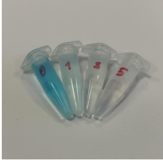
Şekil 5.41: 2 ppm metilen mavisi içeren ve pH değeri 9 olan çözeltinin FTO-ERGO/TiO 2 /Al(60) fotoelektrodu ile gerçekleştirilen giderimi sonucu gözlemlenen renk değişimleri.
