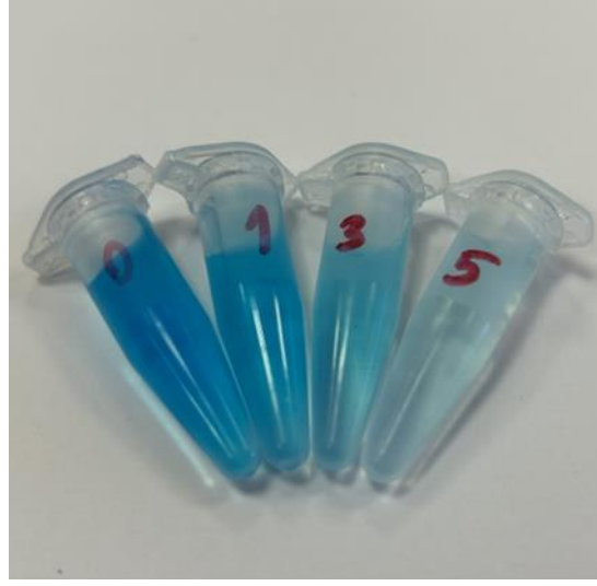
Şekil 5.30: 10 ppm metilen mavisini içeren çözeltinin FTO-ERGO/TiO 2 /Al(60) fotoelektrodu ile gerçekleştirilen giderimi sonucu gözlemlenen renk değişimi.
