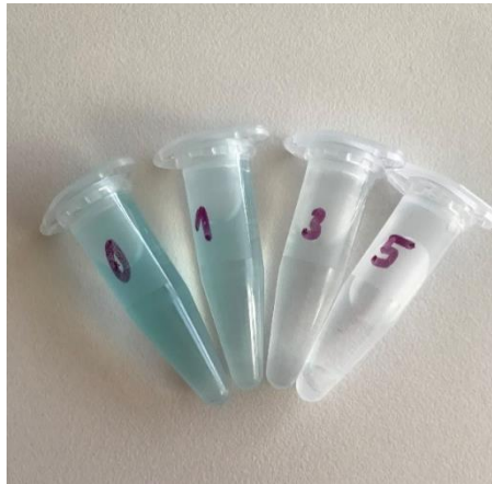
Şekil 5.36: 1 ppm metilen mavisi içeren çözeltinin FTO-ERGO/TiO 2 /Al(60) fotoelektrodu ile gerçekleştirilen giderimi sonucu gözlemlenen renk değişimi.
