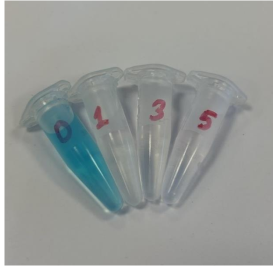
Şekil 5.43: 2 ppm metilen mavisi içeren ve pH değeri 11 olan çözeltinin FTO-ERGO/TiO 2 /Al(60) fotoelektrodu ile gerçekleştirilen giderimi sonucu gözlemlenen renk değişimleri.
