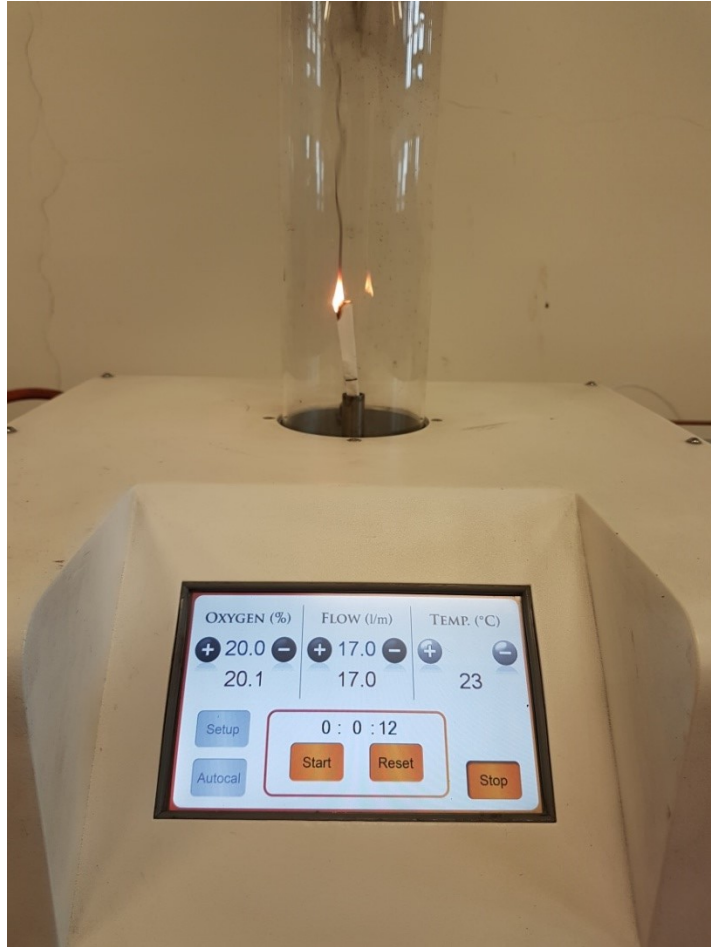
Şekil 3.10: Oksijen indisi işlem A ile numune Beyaz 30 deney görüntüsü.
