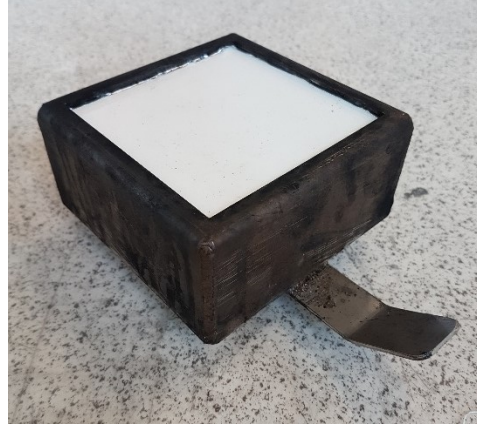
Şekil 3.3: Konik kalorimetre numune hazırlığı.
