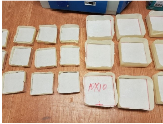
Şekil 3.2: Numune altlıklarının ve karışımlarının hazırlanması.
