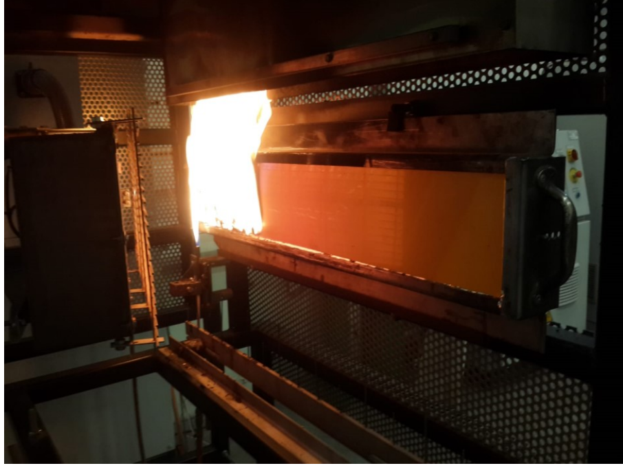
Şekil 3.7: Yanal alev yayılması deney düzeneğinin şematik gösterimi.
