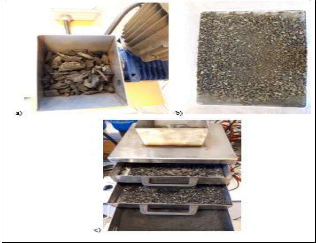
Şekil 3.10: Biyoçarın boyutlandırılması; a) Gazlaştırma sisteminden alınan biyoçarlar, b) Boyutlandırma ünitesinde işlem gören biyoçarlar, c) Titreşimli ayırıştırma ünitesinden geçerek boyutlandırılması yapılan biyoçarlar.
