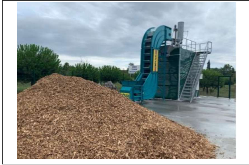
Şekil 3.1: Gebze Teknik Üniversitesi’nde bulunan sabit yataklı yukarı yönlü gazlaştırma sistemi.
