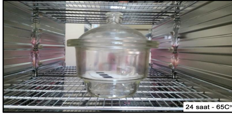
Şekil 3.6: Numunelerin gaz fazında DMDCS buharı ile kaplanması.
