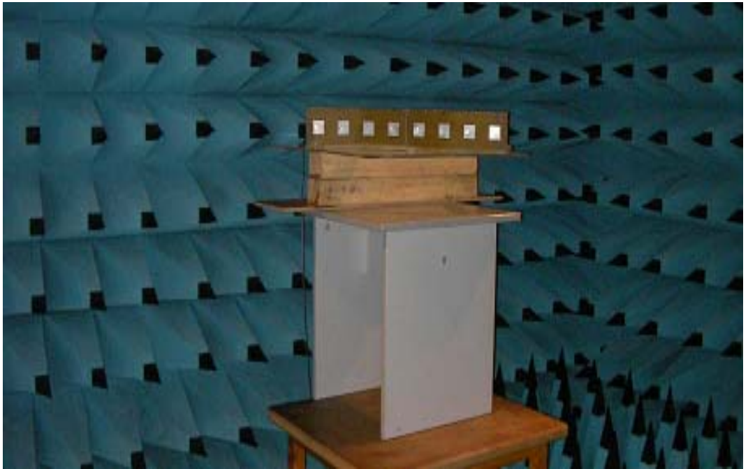
Şekil 6.4. Yarı yansız oda içinde anten dizisi ve yerleşimi.
