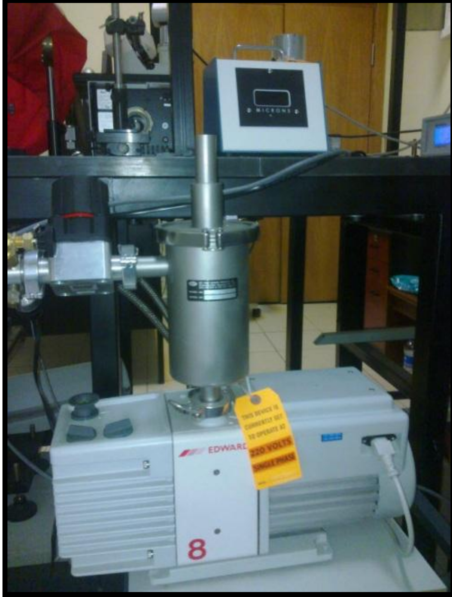
Şekil 3.3: Vakum pompası ve göstergesi.
