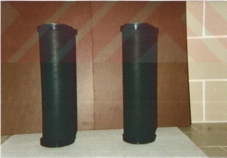
Şekil 5.8. 0.5 \mu\text{m} gözenek \text{\AA} apına sahip filtre kartuşları, bunlar aktif karbondan yapılmıştır. CERAMIKX, KX Industries. Organik bileşiklerin gideriminde kullanılırlar.
