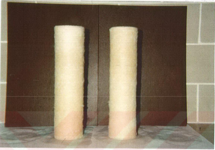
Şekil 5.5. 10 \mu\text{m} gözenek \text{çapına} sahip filtre kartuşları, PURTRES PX10-10
