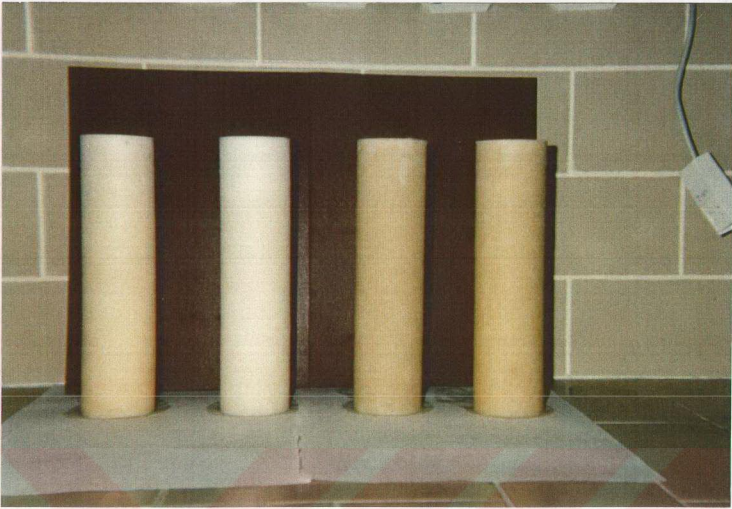
Şekil 5.7. 1 \mu\text{m} gözenek \text{\AA} apına sahip filtre kartuşları, Cheng-Chung
