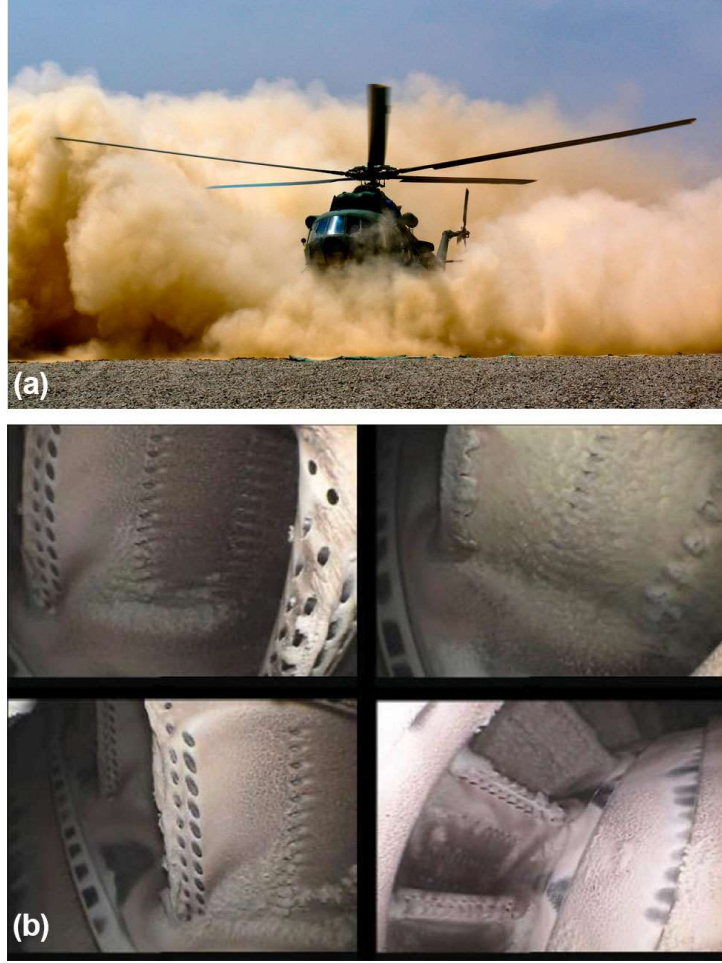
Şekil 2.7: (a) Çöl Şartlarında çalışan bir askeri helikopter ve motorun etkisinde kaldığı çevresel şartlar (b) Hizmet sonrası kum birikintileri ve CMAS etkisinde arızaları bulunan motor bileşenleri [40].
