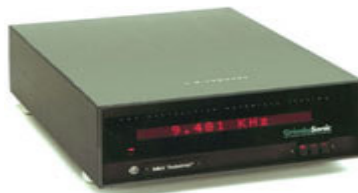
Şekil 6.2 Elastiklik modülünün tayininde kullanılan test cihazı.
