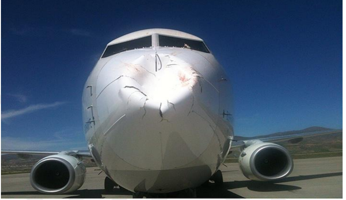
Şekil 2.3: Kuş çarpması sonucu uçağın gövdesinde meydana gelen hasar (Web 4, 2015).
