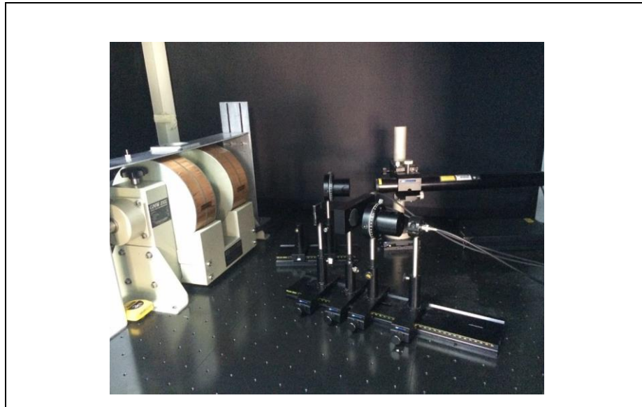
Şekil 3.10: GTU Fizik Bölümü'ndeki manyetik-optik Kerr etkisi sistemi.
