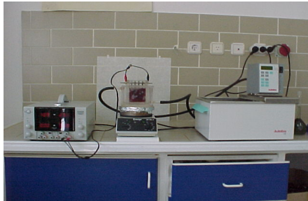
Şekil 4.1. Kesikli EC proses çalışmalarında kullanılan deney düzeneği
