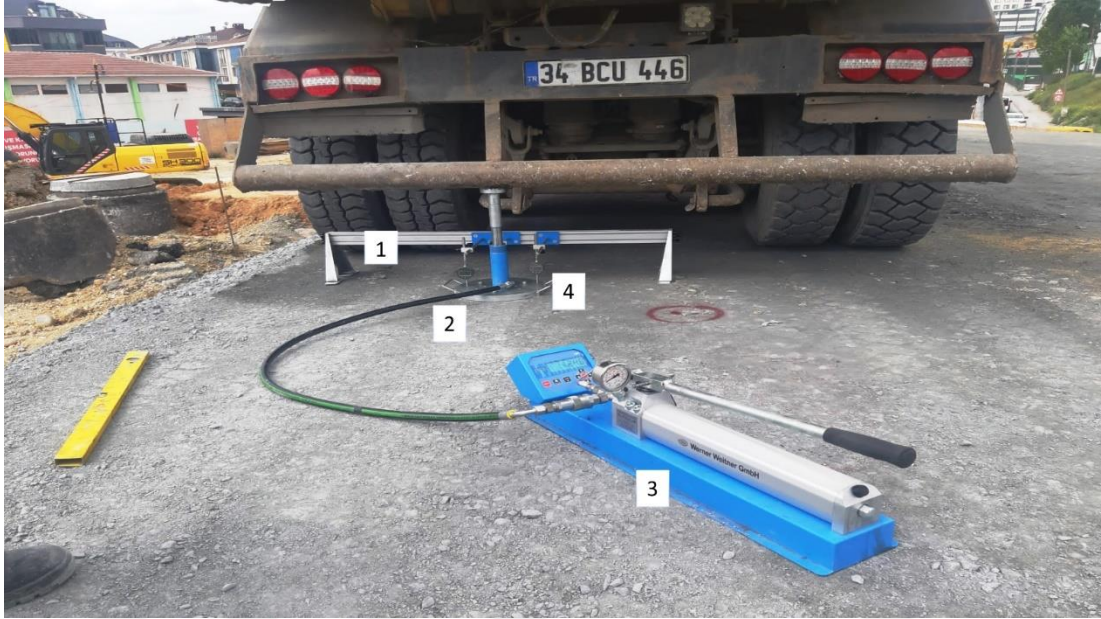
Şekil 2.17: Plaka yükleme deneyi düzeneği, Beylikdüzü, İstanbul.
