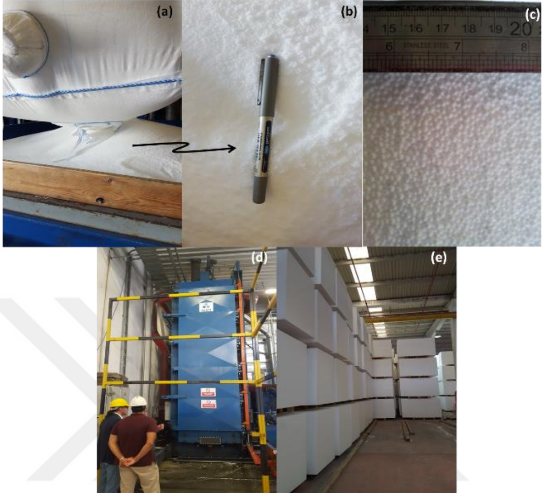
Şekil 2.5: EPS blok üretim aşamaları (a-b) hammadde (c) ön şişirme işlemi (d) ön şişirilme sonrası kalıplama aşaması (e) kalıplama sonrası stok sahasına alınan bloklar [Özer, 2020].
