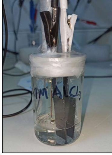
Şekil 3.19: Uzun uçlu grafit plakalarla hazırlanmış olan bir beher yarım hücre.
