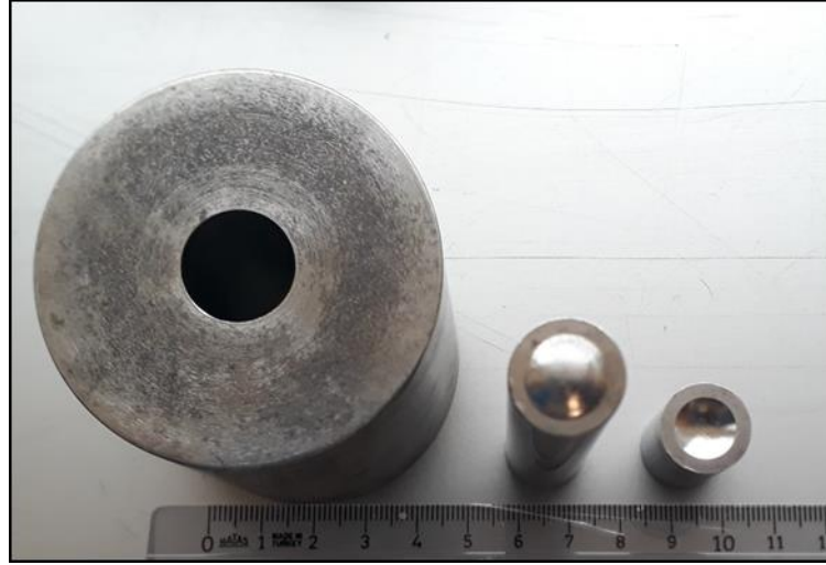
Şekil 3.7: Seramik kapak üretiminde kullanılan pres kalıbı.
