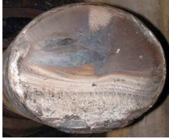
Şekil 3.1. Tren aksında yorulma kırılması.
