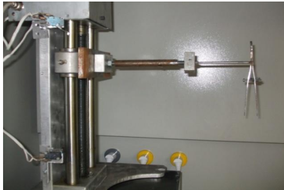
Şekil 8.14. Hızlı daldırma(dipping) kaplama cihazı.
