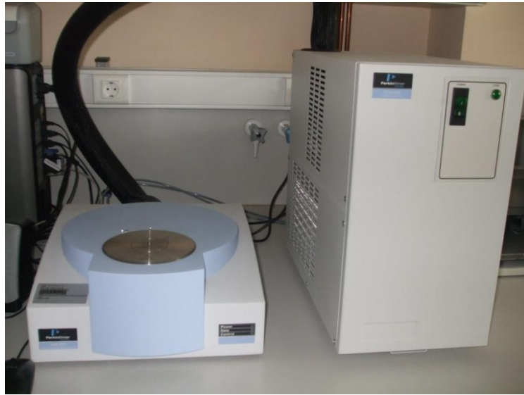
Şekil 8.17. Camsı geçiş sıcaklığı ölçüm cihazı.
