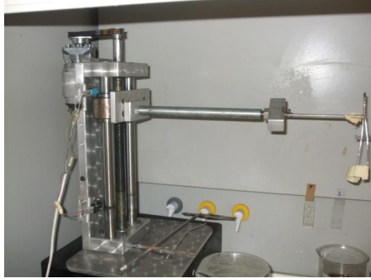
Şekil 8.13. Yavaş daldırma(dipping) kaplama cihazı.
