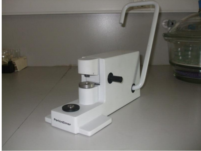
Şekil 8.16. Camsı geçiş sıcaklığı sıcaklığı ölçümü için numune(pan) hazırlama aparatı.
