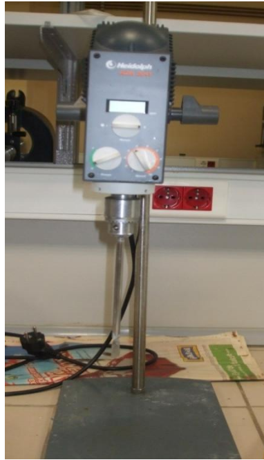
Şekil 9.1. Çökme yapan lateksleri karıştırmada kullanılan karıştırıcı.
