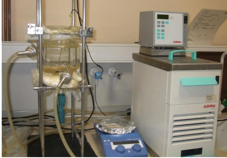
Şekil 8.9. Cam reaktör, kontak termometre ve su sirkülatörü.
