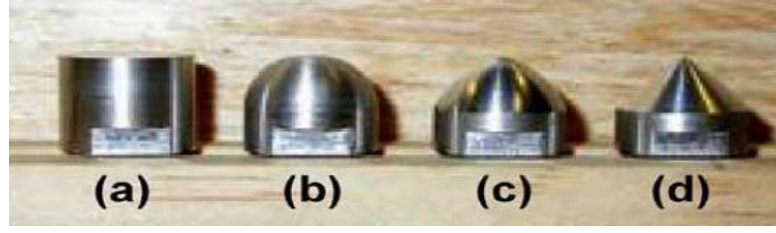
Şekil 5.16: Ağırlık düşürme testinde kullanılan farklı geometrideki uçlar, a) düz tip, b) yarım küresel tip, c) yuvarlak şekilli konik (ogival) tip, d) konik tip uç.
