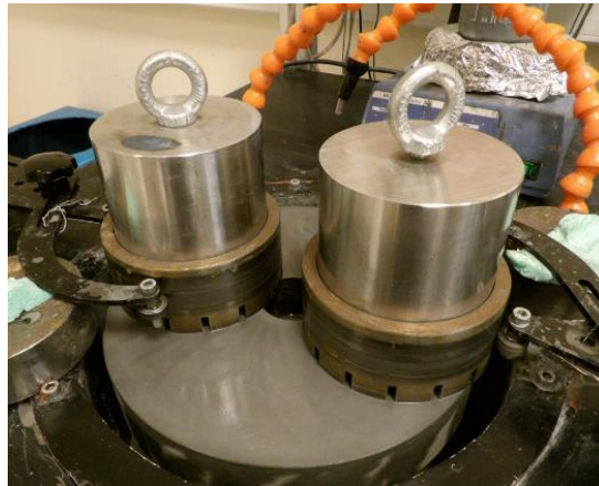
Şekil 5.9: Numunelerin zımparalanmasında kullanılan lepleme makinesi.
