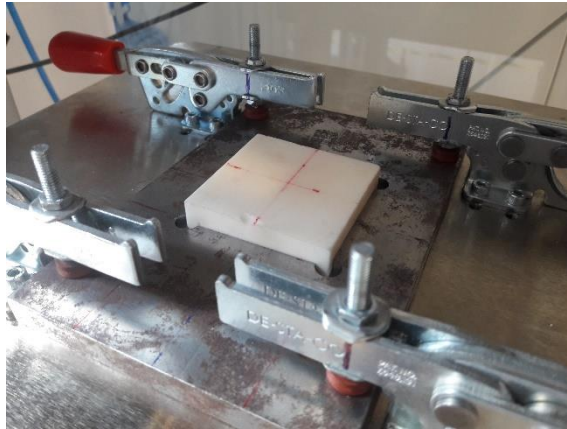
Şekil 5.17: Numune koyulan destek alümina levhanın yerleşimi.
