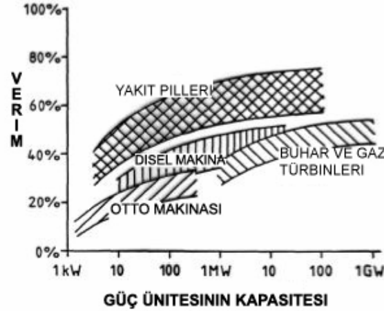
Şekil 2.2. Yakıt pilleri ve alışlagelmiş güç üretim sistemlerinin verimlerinin karşılaştırılması [Kordes and Günter 1996 ].
