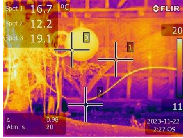
Şekil 3.40: Nizamettin-Zülfiye Evi kış dönemi kuzey cephe termal kamera ölçümü.
